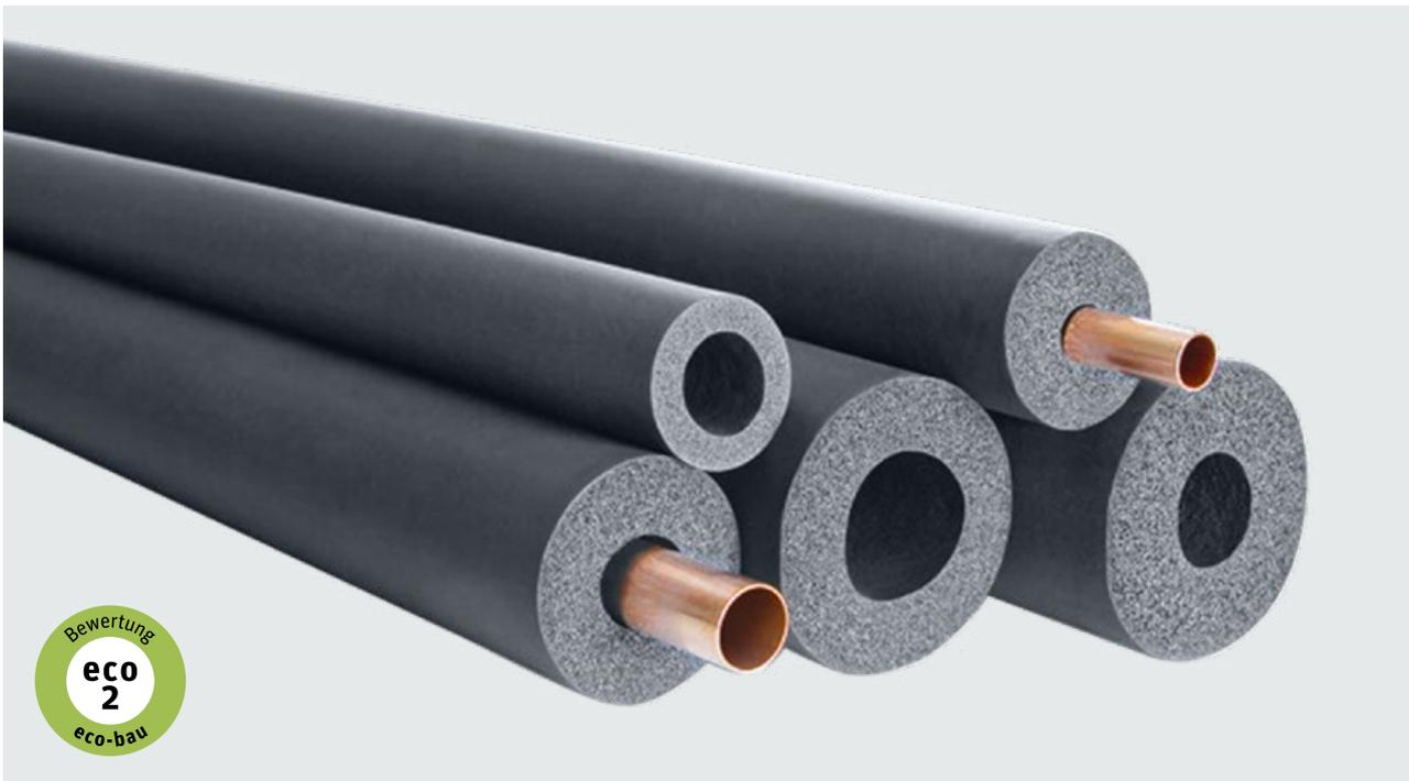
Elastomer-Dämmstoffe wie NH/Armaflex schützen die Anlagenteile sicher vor dem Entstehen von Tauwasser und Energieverlusten. Armaflex-Dämmstoffe benötigen keine zusätzliche Dampfbremse. Der Wasserdampf-Diffusions-Widerstand baut sich bei Armaflex-Produkten über die gesamte Dämmschichtdicke – Zelle für Zelle – auf.
