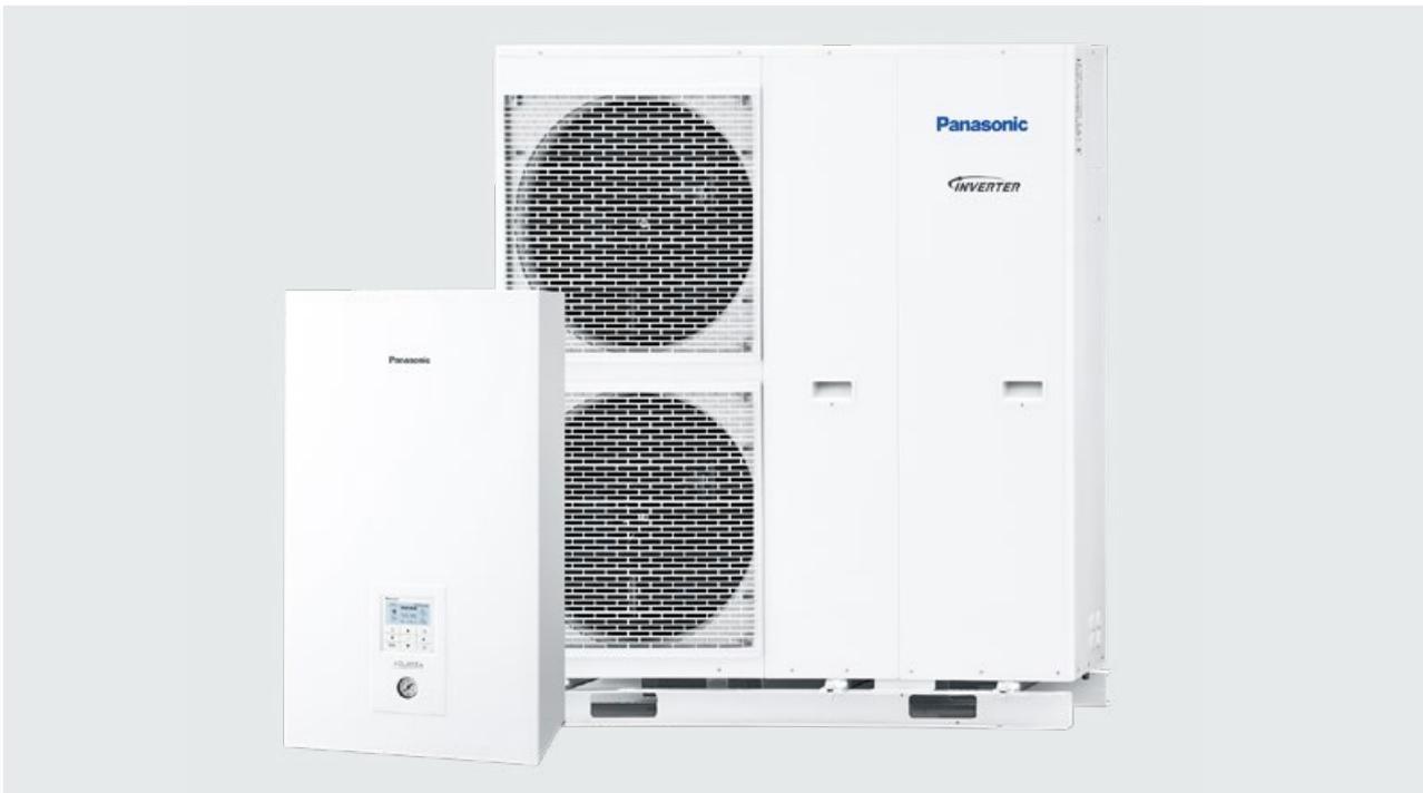
T-CAP SuperQuiet Geräte können dadurch selbst an Standorten installiert werden, wo der Abstand zum Nachbarhaus sehr knapp bemessen ist. Damit sind sie die ideale Wahl bei dicht bebauten Neubaugebieten und als Ersatz für in die Jahre gekommene Öl- oder Gas-Heizungen. Erreicht wurde die Geräuschminimierung durch die Schallisolation des Verdichters mit absorbierenden Materialien wie man sie aus dem Fahrzeugbau oder der Geräuschdämmung hochwertiger Computersysteme kennt.
