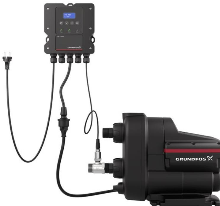
Das wandmontierte Schaltgerät PM GUARD überwacht permanent den Vordruck. Fällt dieser unter einen voreingestellten Schwellenwert, schaltet das Gerät die SCALA2 automatisch ab. Sobald der Druck über den Schwellenwert steigt, wird die Anlage wieder in Betrieb gesetzt. Vertrauen Sie auf die professionellen Lösungen von Grundfos, und sichern Sie sich den PM GUARD für eine optimale und regelkonforme Nutzung Ihrer SCALA2.
