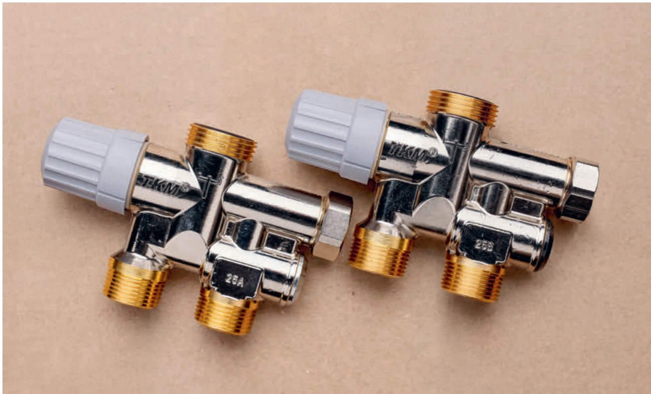
Zwei Beispiele aus dem Thermostatventil-Sortiment, die nur auf den ersten Blick identisch aussehen: Meier Tobler TKM-Einrohrventile mit verschiedenen Bypass-Einstellungen sowie mit oder ohne Ringdrosselung. (Bilder: ss)
