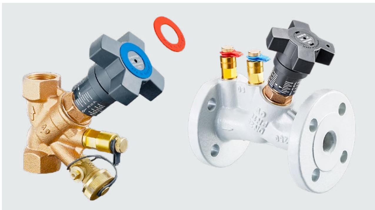
Précis et conviviaux, les robinets d'équilibrage et d'arrêt en bronze (Hydrocontrol VTR, version à filetage et Hydrocontrol VFR, version à bride) et en fonte grise (Hydrocontrol VFC, version à bride) s'utilisent sur les conduites des installations de chauffage central et de refroidissement. Permettant l'équilibrage hydraulique des colonnes entre elles, ils assurent un fonctionnement efficace de l'installation. Ils se montent aussi bien sur l'aller que sur le retour.
