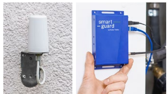
Mit «smart-guard» bestens verbunden: Aussenantenne (links) und GSM-Modem (rechts).
