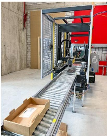
À la sortie de « l'Autostore », les articles commandés sont placés dans des caisses qui sont ensuite fermées sur la ligne de conditionnement avant d'être expédiées.
