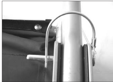
Endzustand des Sicherungsstiftes
