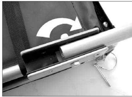
Deichsel in die andere Position klappen,
