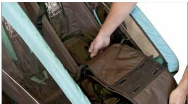
11. Steek de middelste bevestigingsgordel (11) van het babyzitje met de gesp (13) door de lus (14) aan de kruisgordel van het zitje van de Croozer Kid Plus. Steek de gesp (13) in de insteeksluiting (15) van het babyzitje totdat die zichtbaar en hoorbaar vastklikt.
