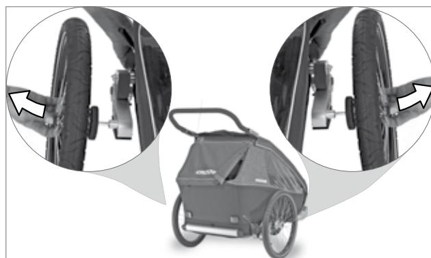
1. Vytáhněte brzdovou páčku (1) až k dorážce dozadu. Brzdové čepy (2 a 4) na obou stranách vozíku Croozer se pohybují nahoru a zasahují do děrovaných disků oběžných kol. Pro lepší přehled je obrázek vpravo znázorněn bez oběžného kola.
