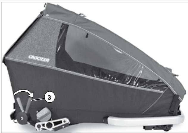
7. Zkontrolujte poté funkčnost zajišťovací brzdy tak, že stisknete páčku (3) dozadu. Ani jedno z kol nesmí být možné otočit.
