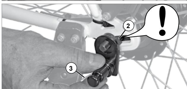
3. Našroubujte přítužnou matici (1) minimálně pěti plnými otáčkami na závit osy plného hřídele.
