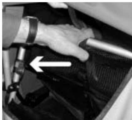
Danach greifen Sie in das Fahrzeug und ziehen den Sitzbügel zurück.
