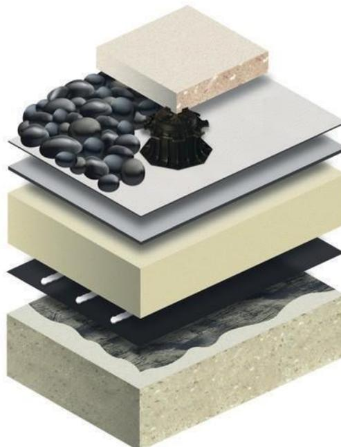
Sistema de Cubierta Caliente Lastrada
