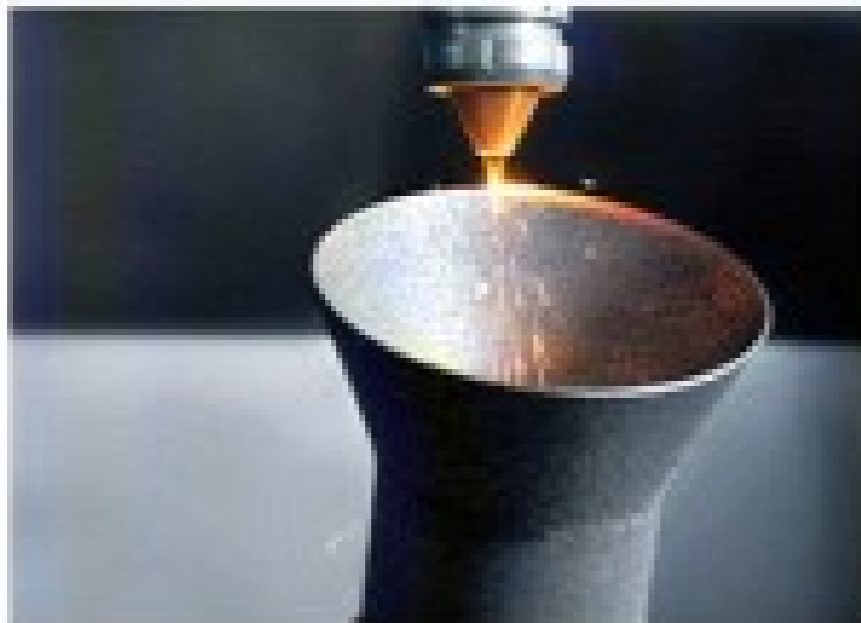
LASERAUFTRAGSSCHWEISSEN 4: Aufbau des Trichters
