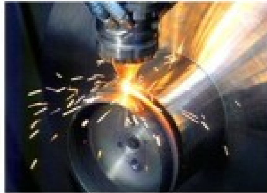
LASERAUFTRAGSSCHWEISSEN 2: Generieren des Bundes ohne Stützgeometrie
