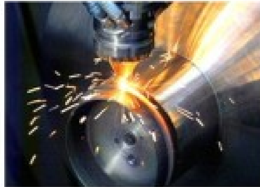
LASERAUFTRAGSSCHWEISSEN 2: Generieren des Bundes ohne Stützgeometrie
