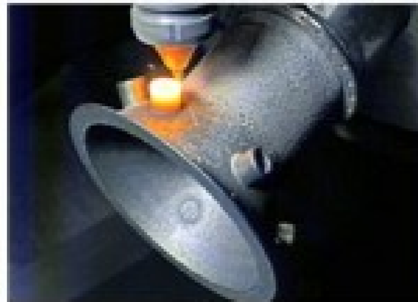
LASERAUFTRAGSSCHWEISSEN 5: Aufbau der 12 Anschlussstutzen
