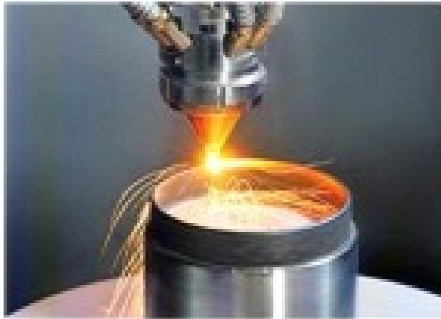
LASERAUFTRAGSSCHWEISSEN 1: Grundaufbau des Gehäuseringes
