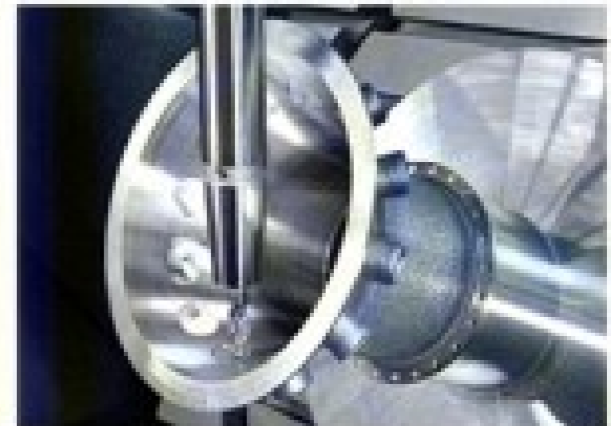
FRÄSBEARBEITUNG 6: Fräsen der kompletten Innenkontur
