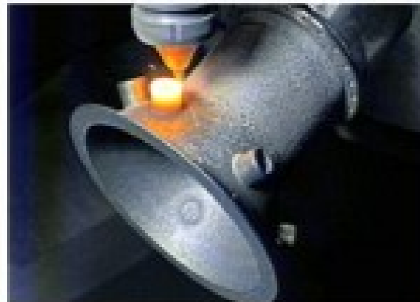
LASERAUFTRAGSSCHWEISSEN 5: Aufbau der 12 Anschlussstutzen
