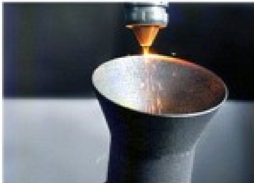
LASERAUFTRAGSSCHWEISSEN 4: Aufbau des Trichters
