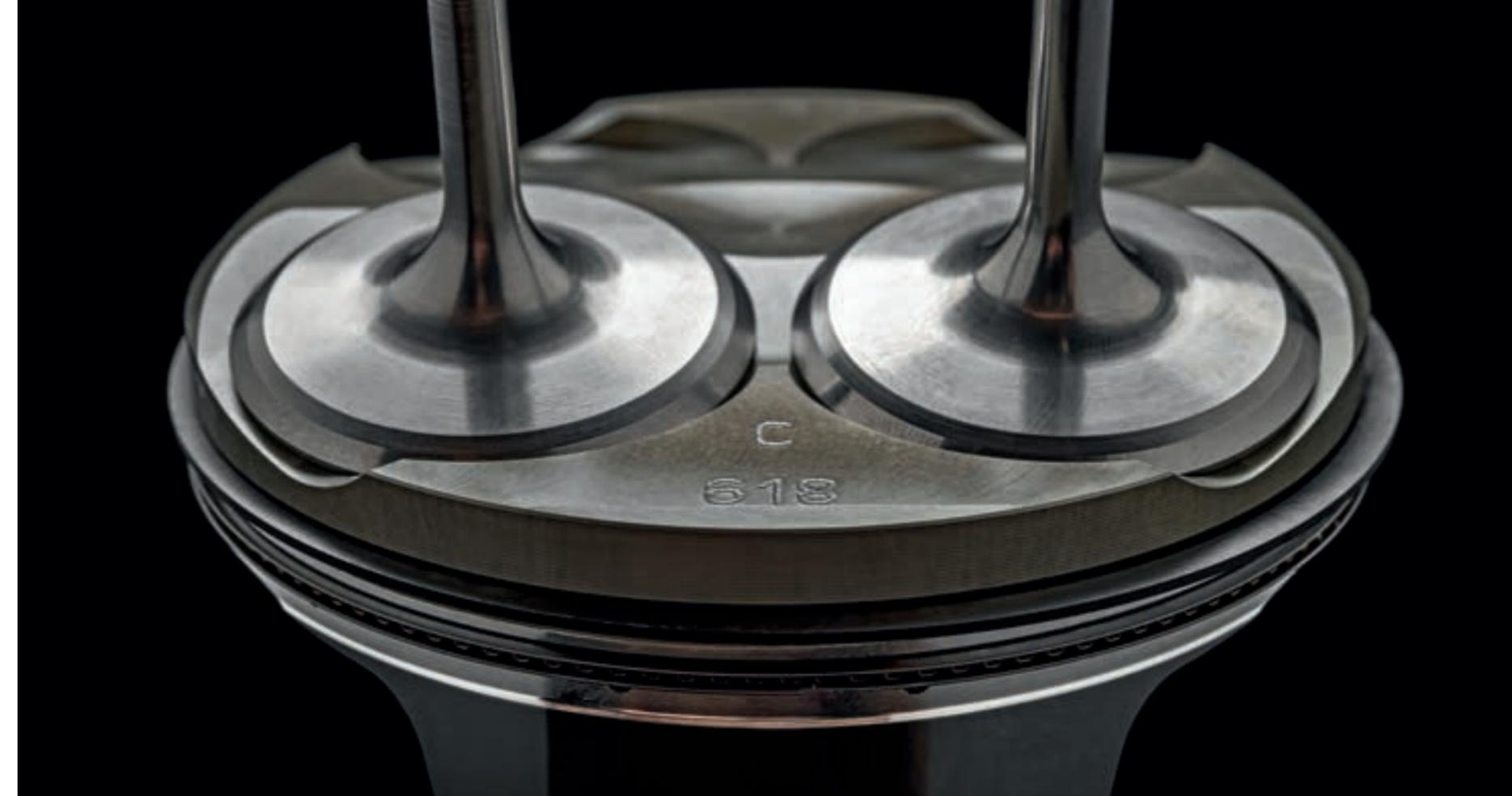
permettent une plus grande levée des soupapes d'admission en titane, qui sont dotées de demi-cônes eux aussi en titane, solution utilisée uniquement sur les moteurs de compétition.
