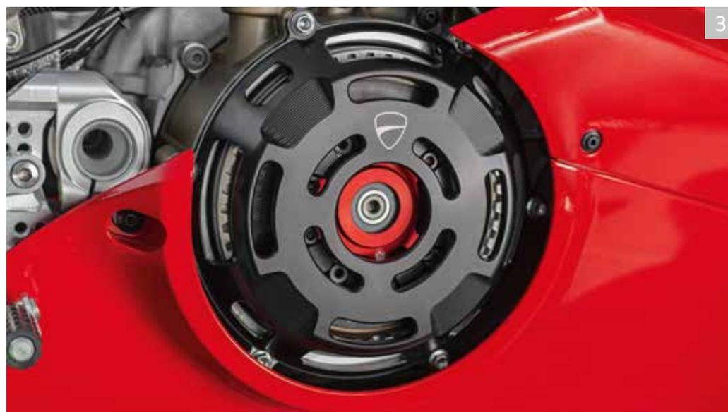
3 Kit d'embrayage à sec. Cache d'embrayage à sec en carbone
