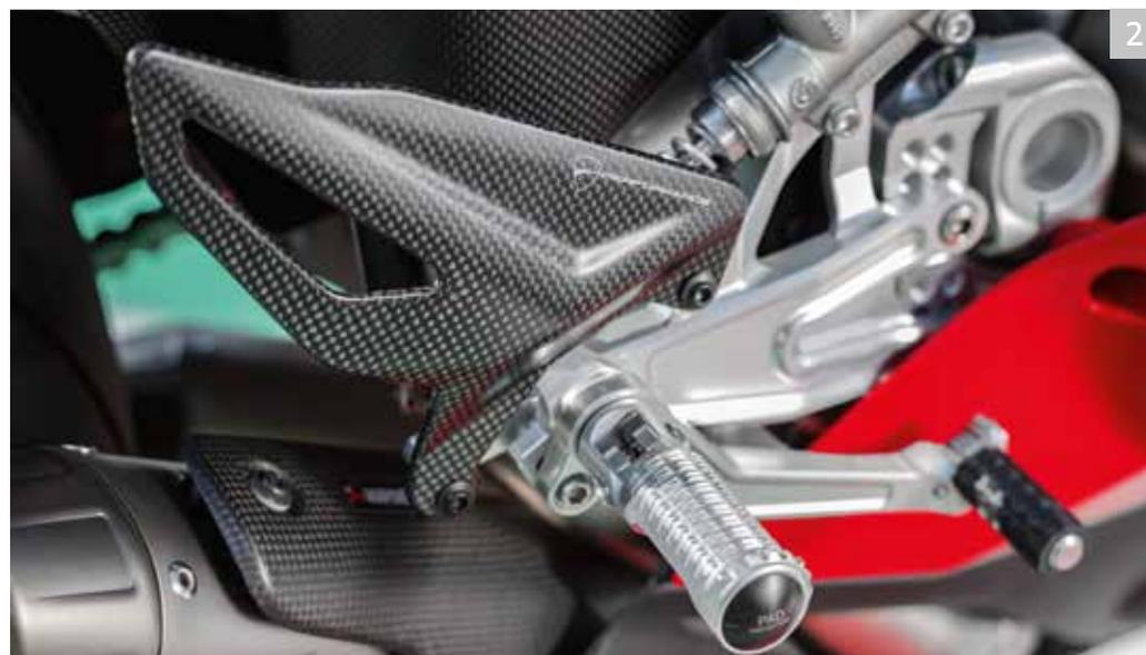
2 Pare-talons en carbone. Repose-pieds pilote réglables en aluminium
