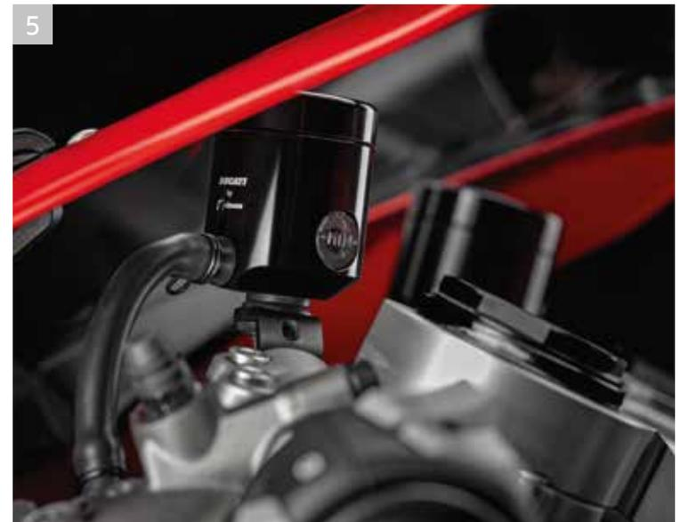
5 Réservoir de liquide de frein. Réservoir de liquide d'embrayage.
