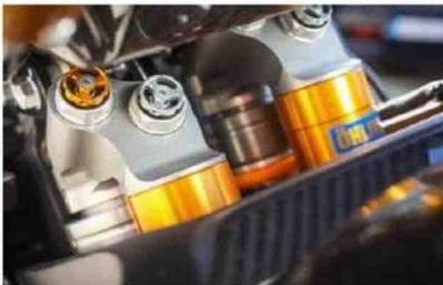
Là où généralement l'unique combiné amortisseur arrière prend place vient s'ajouter celui dédié à la suspension avant. La liaison se faisant par le biais d'une longue biellette passant sous le moteur.
