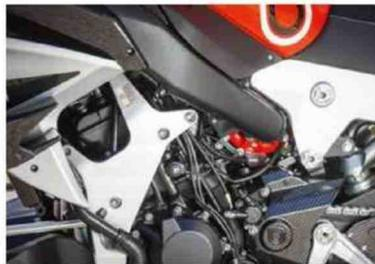
Le carter rouge de turbine du compresseur centrifuge est ici particulièrement en vue, considérant la fonction porteuse du moteur.
