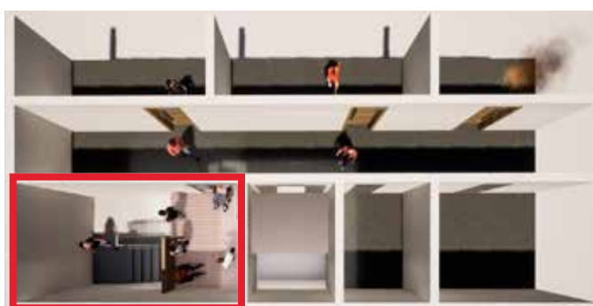
Sicherere Verweilbereich im ausreichend großen Fluchttreppenhaus
