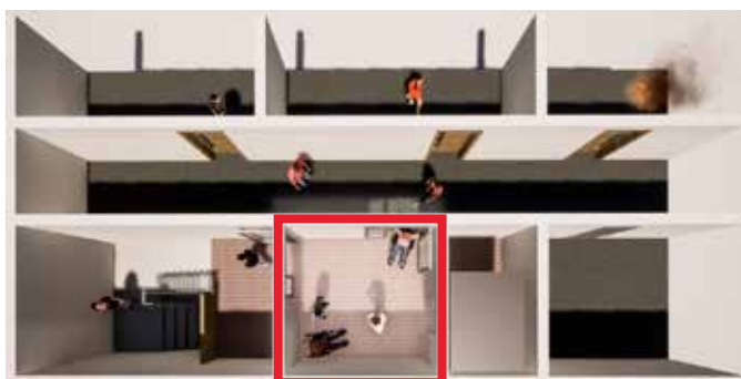
Sicherere Verweilbereich zwischen Feuerwehraufzug und Fluchttreppenhaus
