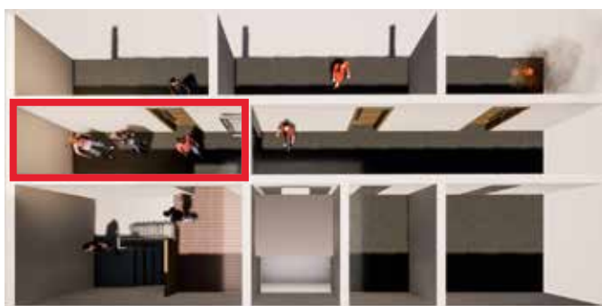
Erweiterung des Fluchttreppenhauses mit einem sicheren Verweilbereich
