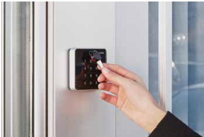
Berechtigungsprüfung mittels Smartkey und Leser
