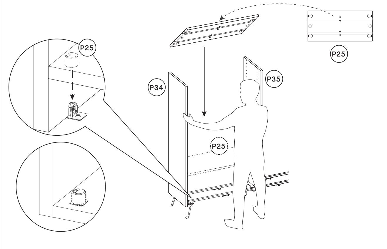
Platziere mit einer zweiten Person die Unterböden **P25** auf der Plattform, in dem du sie zwischen die Seitenwände **P34/P35** setzt.
