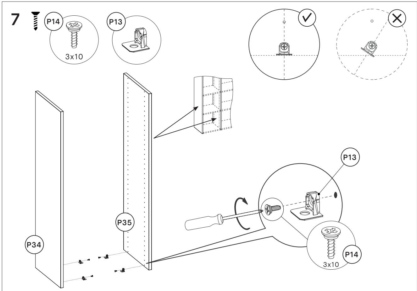
Die Bodenträger (P13) halten die Unterböden. Schraube sie wie oben gezeigt in alle Seitenwände (mit Schraube P14). Du brauchst sie in den untersten Löchern für den Unterboden. Sieh dir dein Design an, um die übrigen Träger zu verteilen. Sie gehören überall dort hin, wo ein Boden sein soll. Bitte halte dich hierfür an den Hinweis 'Vergiss nicht, zu messen' auf S. 10 der Einleitung und platziere die Böden immer genau dort, wo sie benötigt werden.
