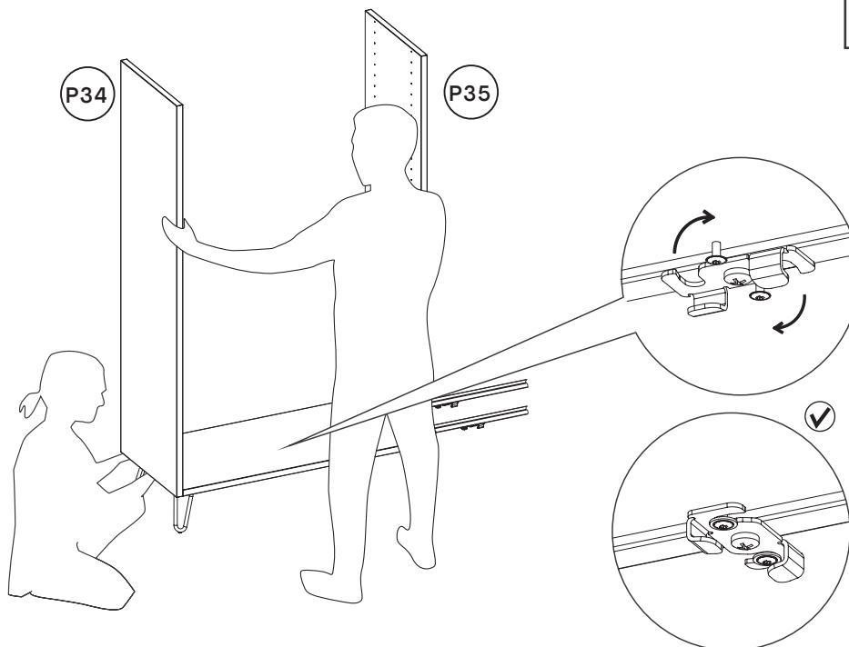
Schraube die Seitenwände an die Unterböden, und drehe das Scharnier unter dem Unterboden, um die Schienen mit dem Boden zu verbinden. Du solltest es klicken hören, sobald das Scharnier eingerastet ist.
