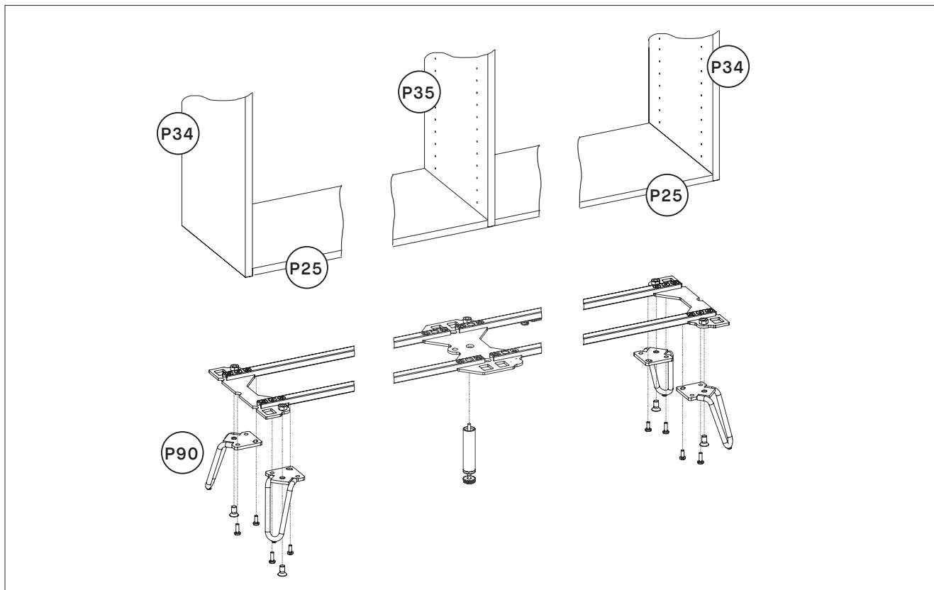
Generell gilt: Die einseitigen Metallplatten gehören zu den Seitenwänden außen und werden mit dem PYN Fußgestell verbunden. Die doppelseitigen Metallplatten gehören zu den Seitenwänden innen und werden für die Stabilität mit dem Stützfuß verbunden.
