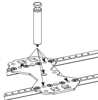
Schraube den Stützfuß **P6** in die Platte **P1**. Um deinen Boden vor Kratzern zu schützen, bringe die Gleiter (**P9**) dem Stützfuß **P6** an.
