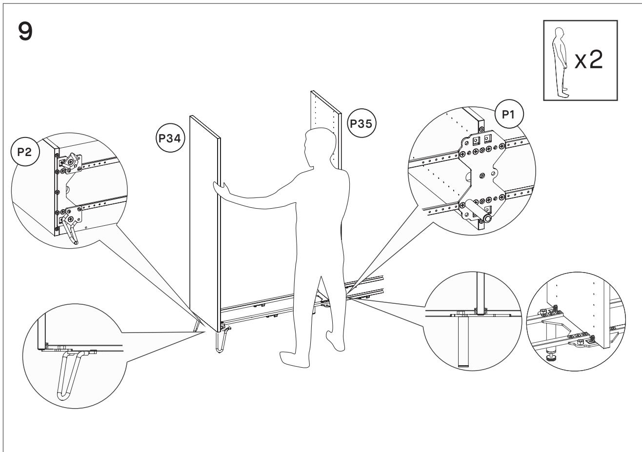
Stecke jetzt die ersten beiden Seitenwände in ihre Metallplatten: Die Seitenwände außen kommen in das Ende der einseitigen Platte P2 und die Seitenwand innen in die Mitte der doppelseitigen Platte P1.
