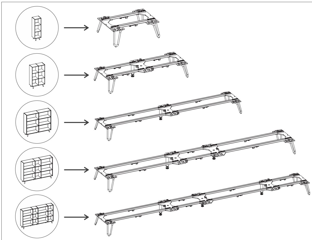
Schau dir links die Beispieldesigns an und wie die dazugehörigen Fußkonstruktionen rechts aussehen. Wähle das Design, dass deinem am ähnlichsten ist und bau deine Fußkonstruktion entsprechend zusammen.
