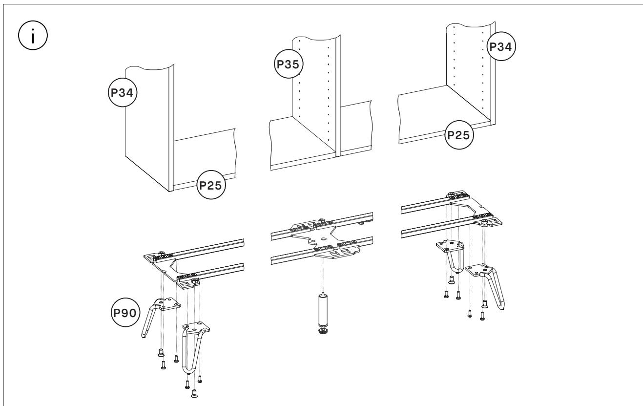
Général : les platines de fixation pied se placent sous les panneaux extérieurs et doivent être reliées aux pieds PYN. Les platines de fixation pieds doubles se placent sous les panneaux intérieurs et doivent être reliés aux pieds de support, qui sont nécessaires pour assurer la stabilité du meuble.
