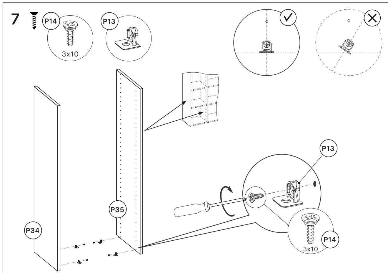
Les ferrures d'assemblage P13 sont là pour maintenir les tablettes rainurées. Vissez-les à tous les panneaux comme illustré ci-dessus (en utilisant la vis P14). Pensez à vérifier votre configuration pour savoir où placer les ferrures. Vous en aurez besoin à chaque endroit où vous devrez placer une tablette. Veuillez suivre "N'oubliez pas de mesurer" dans chapitre "Introduction", page 10, pour trouver le bon positionnement pour chacune des tablettes.
