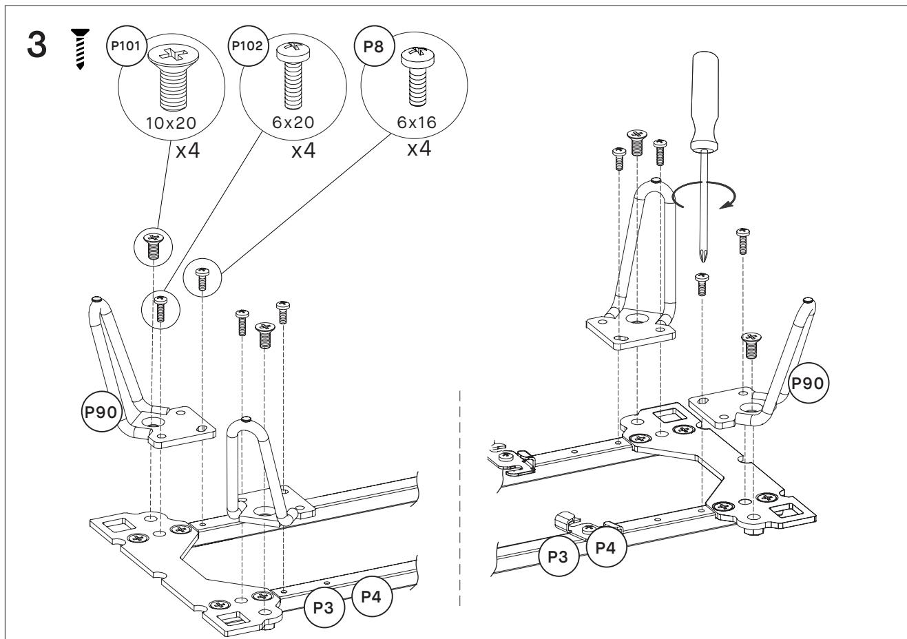
Reliez les pieds PYN (**P90**) aux rails **P3/P4** en utilisant la vis **P101** (10x20 mm), **P102** (6x20 mm) et **P8** (6x16 mm).
