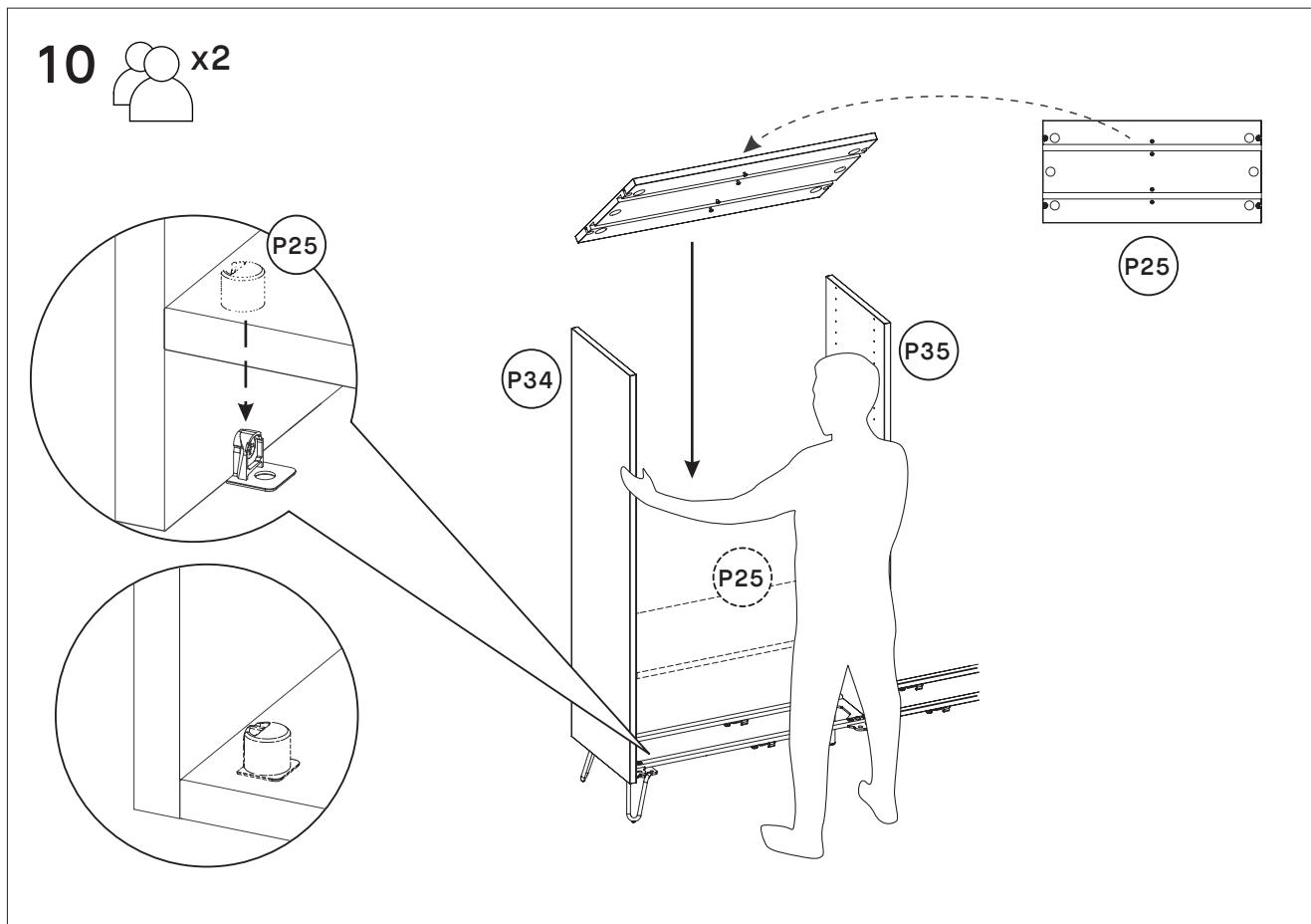
Posez les tablettes rainurées **P25** sur les ferrures d'assemblage pour la joindre aux panneaux verticaux **P34/P35** avec l'aide d'une tierce personne.
