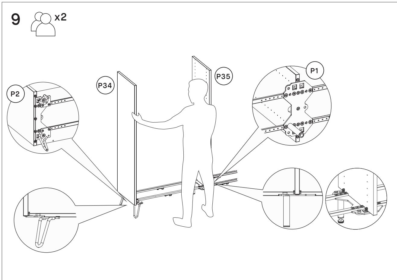
Maintenant, fixez les deux premiers panneaux sur les platines de fixation : les panneaux extérieurs se fixent sur les platines de fixation pied simple **P2**, les panneaux intérieurs se fixent sur les platines de fixation pied double **P1**.
