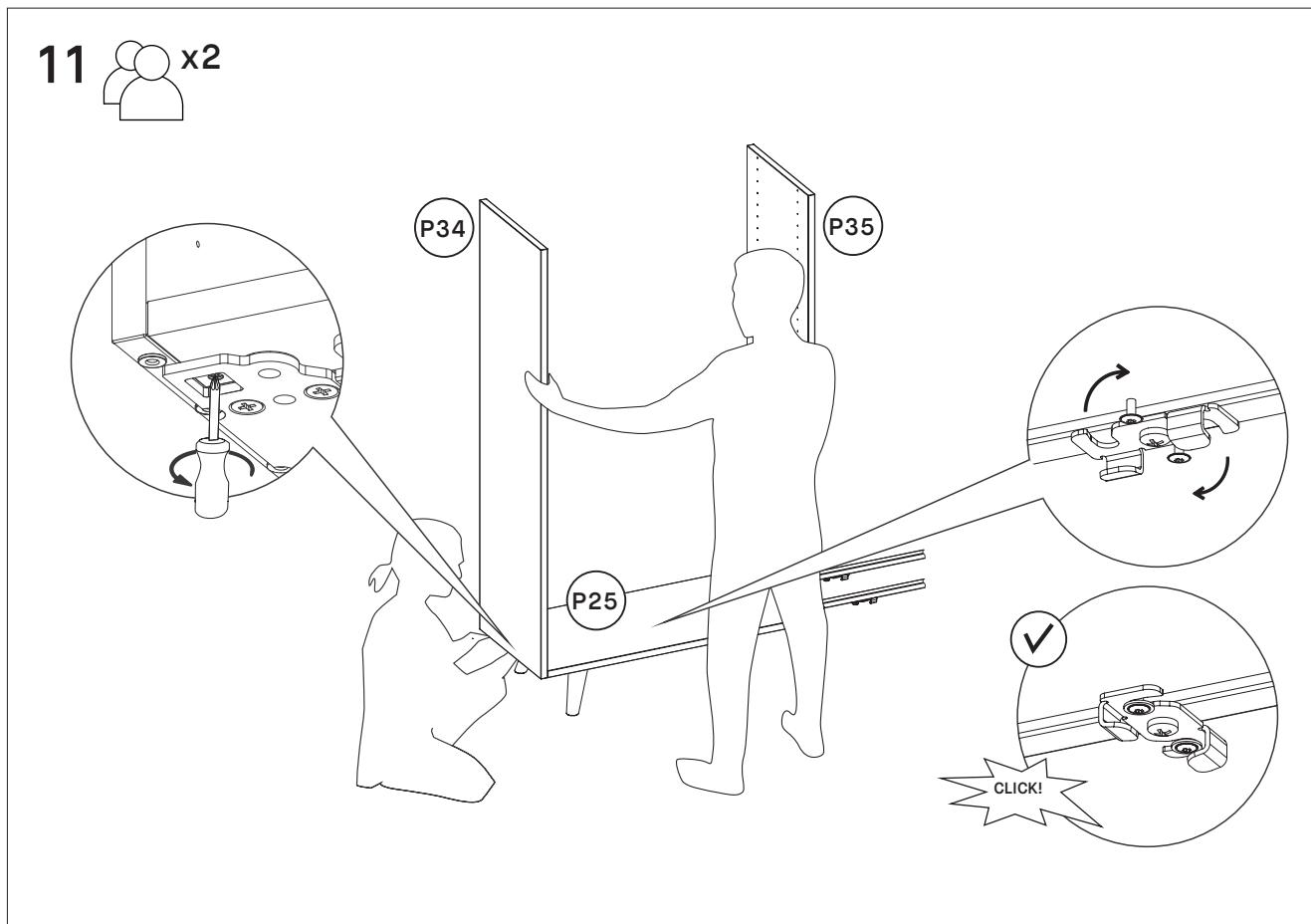
Une fois les tablettes installés, serrez les écrous comme indiqué sur le dessin ci-dessus à gauche. Ensuite verrouillez le loquet des rails sous la tablette rainurée comme indiqué sur le dessin ci-dessus à droite. Vous devriez entendre “clic” lorsque le loquet est dans sa position finale.
