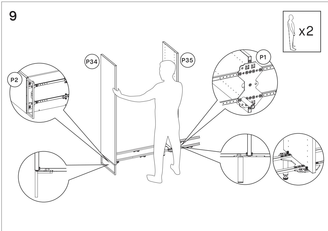
Maintenant, fixez les deux premiers panneaux sur les platines de fixation : les panneaux extérieurs se fixent sur les platines de fixation pied double **P2**, les panneaux intérieurs se fixent sur les platines de fixation pied simples **P1**.
