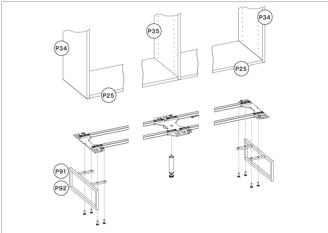
Général : les platines de fixation pied se placent sous les panneaux extérieurs et doivent être reliées aux pieds SYMPLE. Les platines de fixation pieds doubles se placent sous les panneaux intérieurs et doivent être reliés aux pieds de support, qui sont nécessaires pour assurer la stabilité du meuble.
