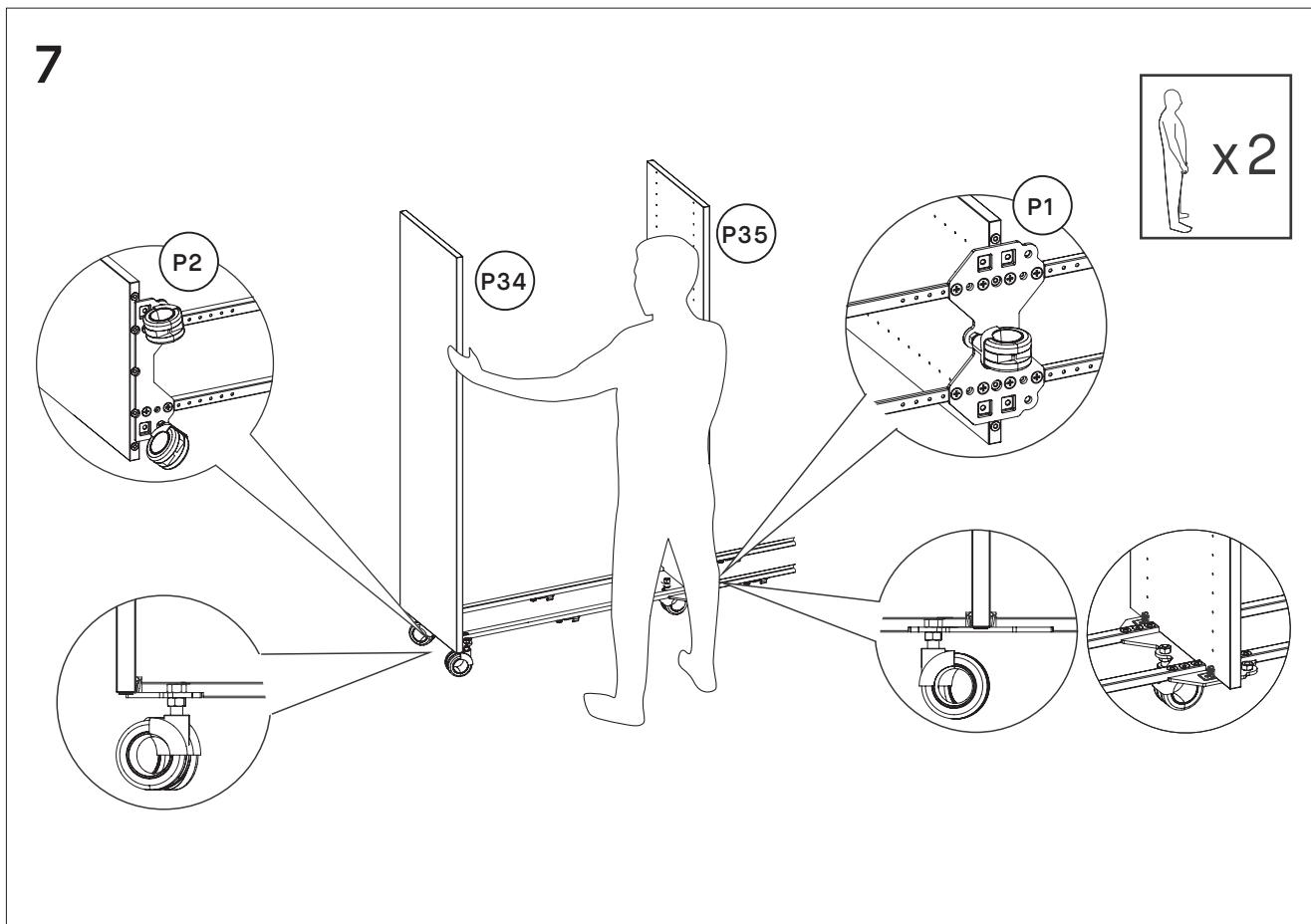
Maintenant, fixez les deux premiers panneaux à leurs platines de fixation : les panneaux extérieurs se placent au bout du platine de fixation pieds **P2**, le panneau intérieur se place au milieu du platine de fixation double **P1**.
