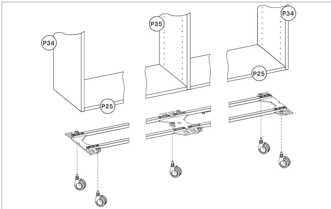
Général : les platines de fixation pied doubles se placent sous les panneaux extérieurs et les platines de fixation pied se placent sous les panneaux intérieurs.
