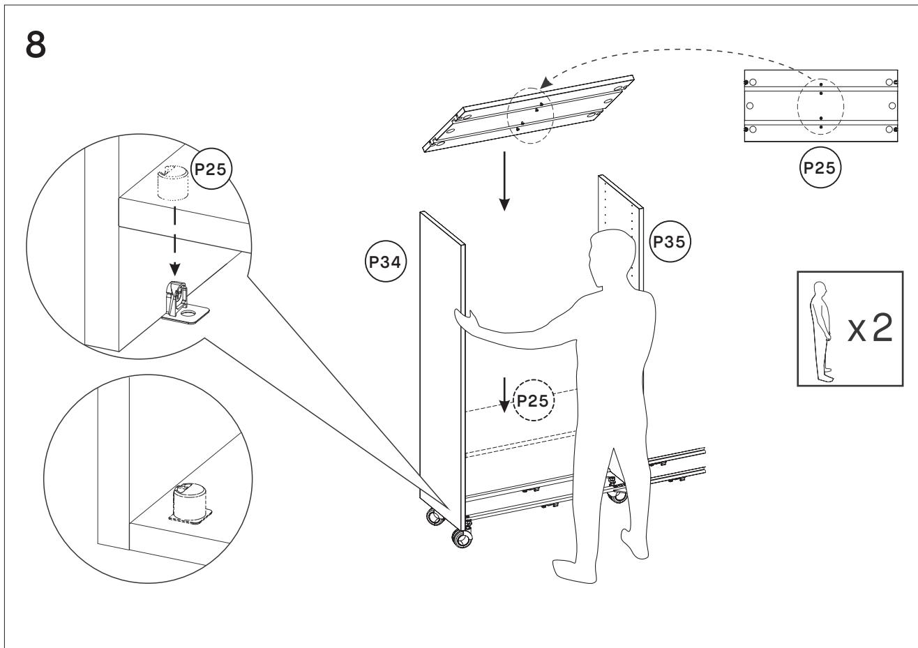
Placez les tablettes rainurées P25 sur le platine de fixation en les joignant aux panneaux P34/
