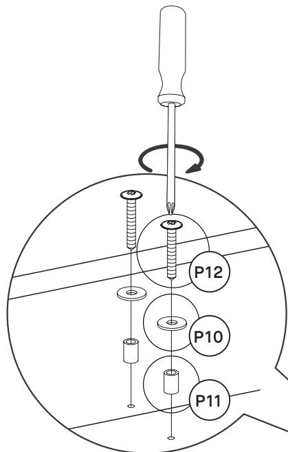
Préparez maintenant les tablettes rainurées pour qu'elles soient reliées au reste du montage. Vissez avec l'entretoise **P11** et la rondelle **P10** aux tablettes rainurées **P25** en utilisant la vis **P12** (3,5x25 mm).
