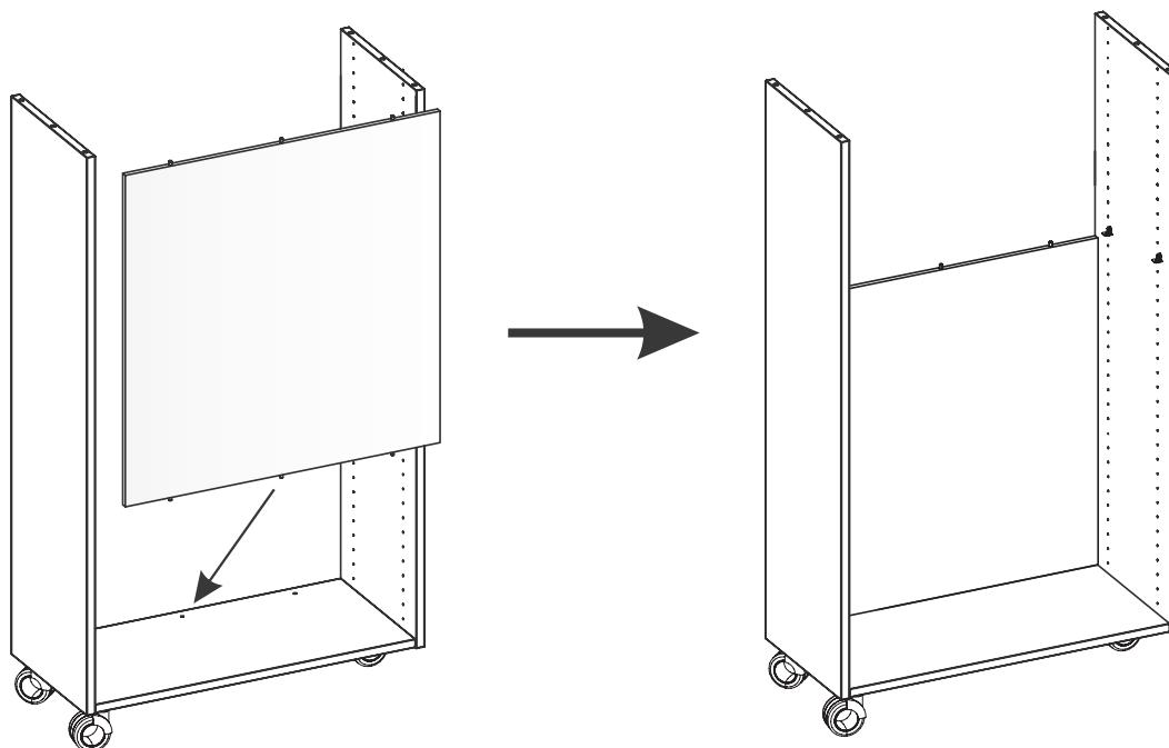
**NOTE :** chaque compartiment (partie entre deux panneaux et les plateaux qui les relie entre eux) a besoin d'au moins un panneau de fond pour assurer la stabilité. L'installation des panneaux de fond sera expliquée dans les pages suivantes.
