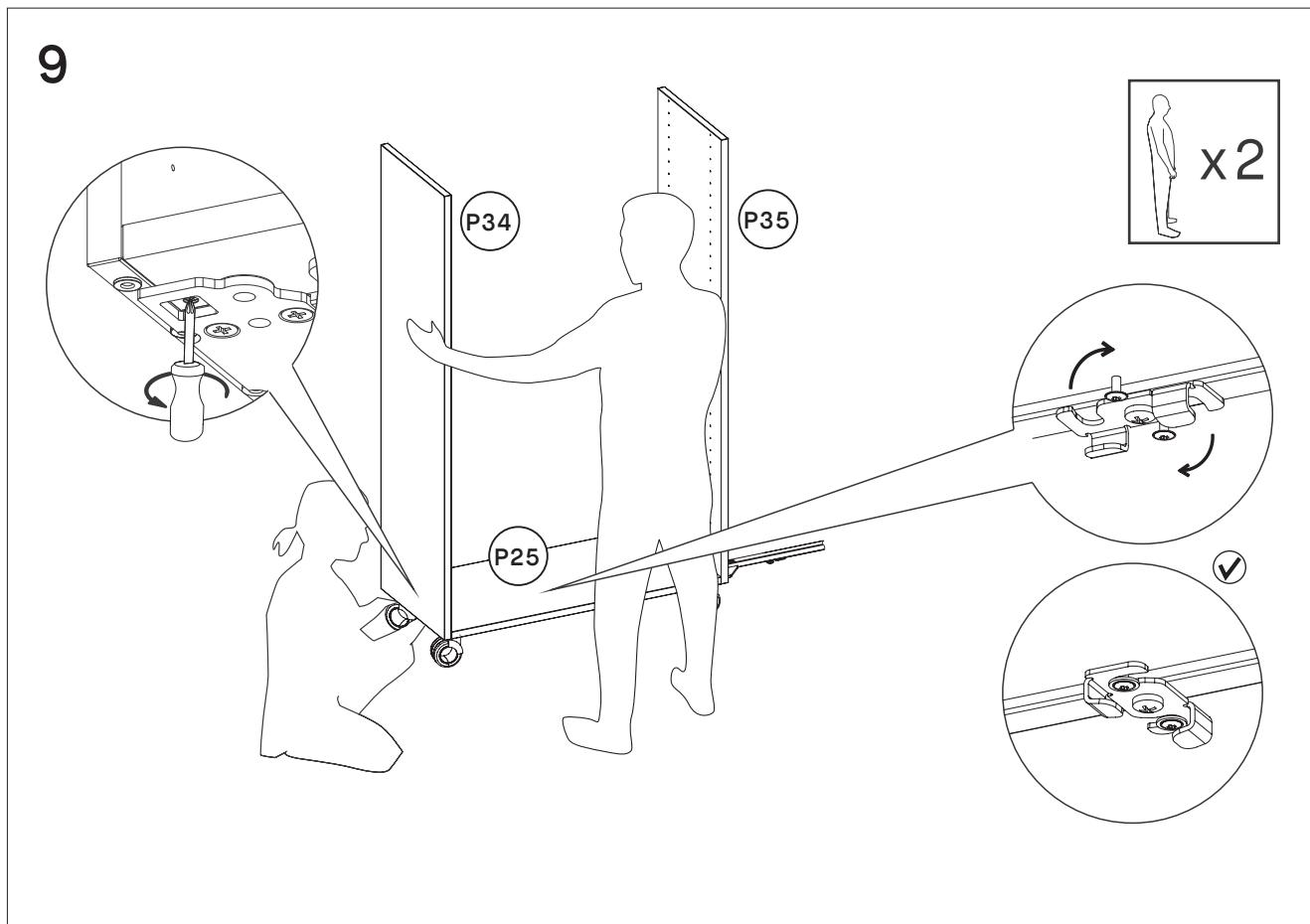
Vissez les panneaux **P34/P35** aux tablettes rainurées et verrouillez le loquet sous la tablette rainurée pour relier les rails à la tablette. Vous devriez entendre “clic” lorsque le loquet est dans sa position finale.
