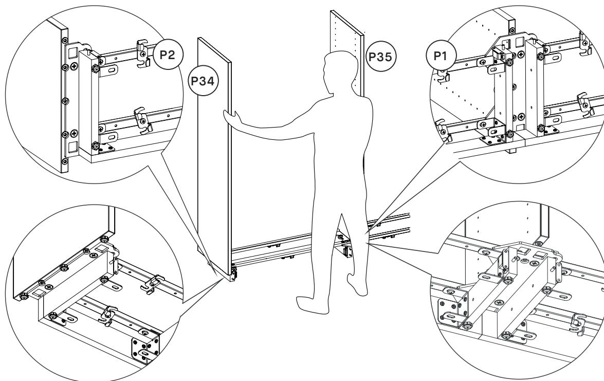
Stecke jetzt die ersten beiden Seitenwände in ihre Metallplatten: Die Seitenwände außen kommen in das Ende der einseitigen Platte P2 und die Seitenwand innen in die Mitte der doppelseitigen Platte P1.
