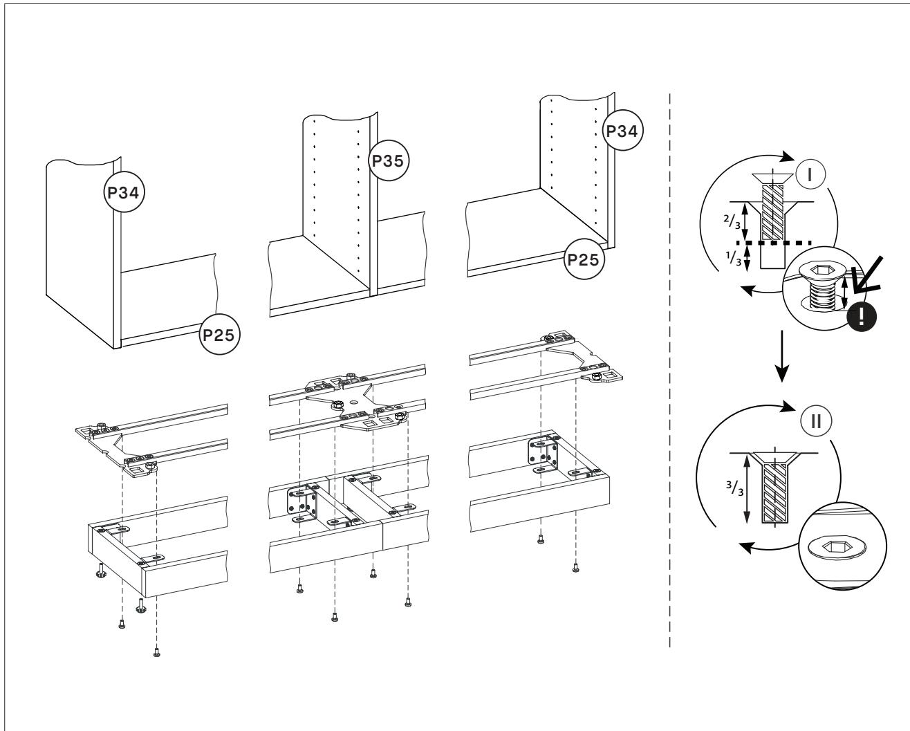
Generell gilt: Die einseitigen Platten gehören unter die Seitenwände außen, die doppelseitigen Platten unter die Seitenwände innen.
