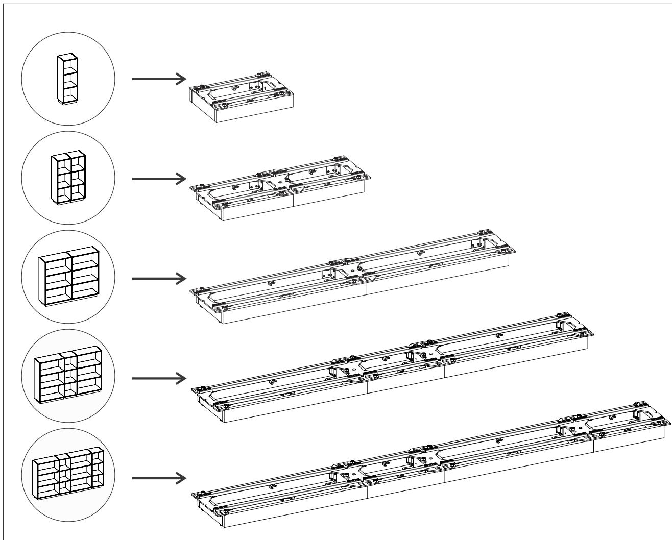
Schau dir links die Beispieldesigns an und wie die dazugehörigen Fußkonstruktionen rechts aussehen. Wähle das Design, das deinem am ähnlichsten ist und bau deine Fußkonstruktion entsprechend zusammen.
