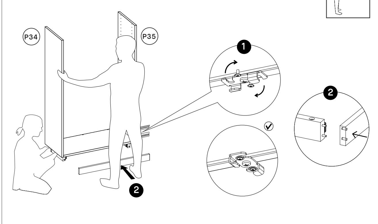
1. Setze das Scharnier unter den Unterboden, um die Schienen mit dem Boden zu verbinden. Du solltest es klicken hören, sobald das Scharnier eingerastet ist.
