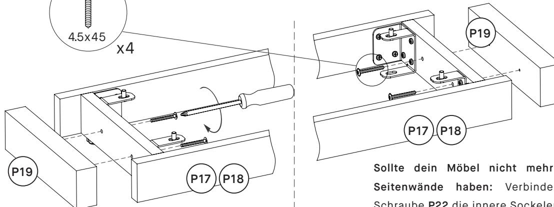
Sollte dein Möbel nicht mehr als zwei Seitenwände haben: Verbinde mit der Schraube P22 die innere Sockelerweiterung P19 mit deinen Sockeln P17/P18 (abhängig von deinem Design).
