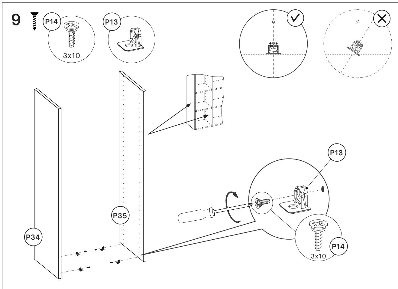
Die Bodenträger (P13) halten die Unterböden. Schraube sie wie oben gezeigt in alle Seitenwände (mit Schraube P14). Du brauchst sie in den untersten Löchern für den Unterboden. Sieh dir dein Design an, um die übrigen Träger zu verteilen. Sie gehören überall dort hin, wo ein Boden sein soll. Bitte halte dich hierfür an den Hinweis 'Vergiss nicht, zu messen' auf S. 10 der Einleitung und platziere die Böden immer genau dort, wo sie benötigt werden.
