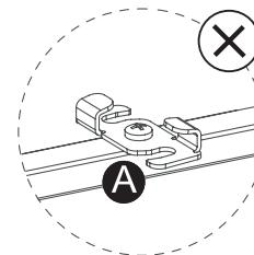
Sollte dein Möbel nicht mehr als zwei Seitenwände haben: Verbinde mit Schraube P108 die Sockelkonstruktion mit dem einseitigen Metallplattenende P2 wie oben abgebildet. Stelle sicher, dass die Position des Scharniers mit A (rechts) übereinstimmt.
