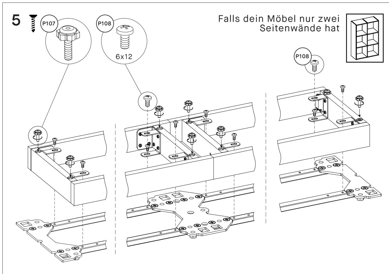
**Sollte dein Möbel mehr als zwei Seitenwände haben:** Verbinde wie oben abgebildet mit Schraube P108 die Sockelkonstruktion mit den Metallplatten.
