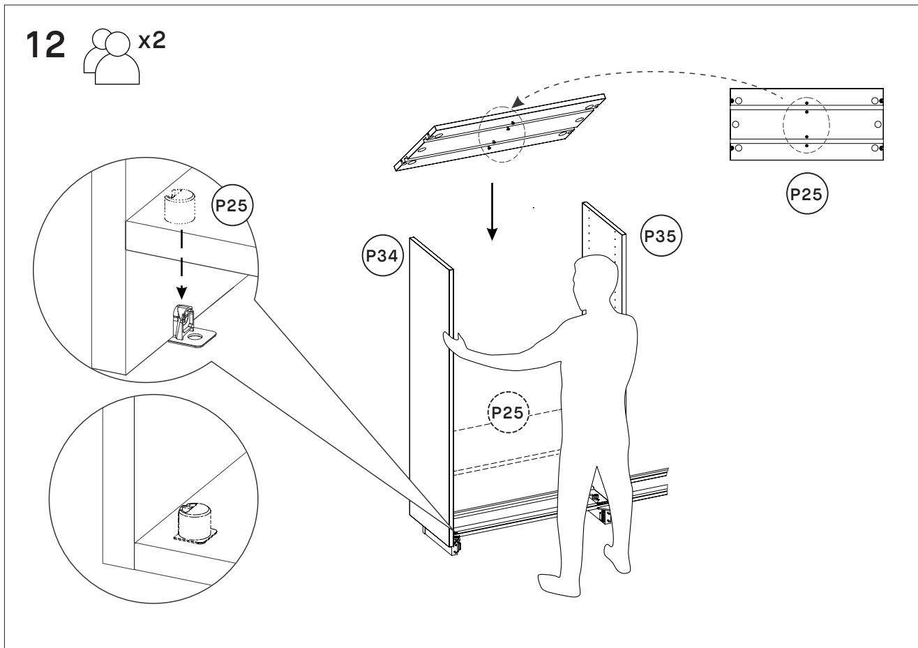
Platziere mit einer zweiten Person die Unterböden P25 auf der Plattform, in dem du sie zwischen die Seitenwände P34/P35 setzt.
