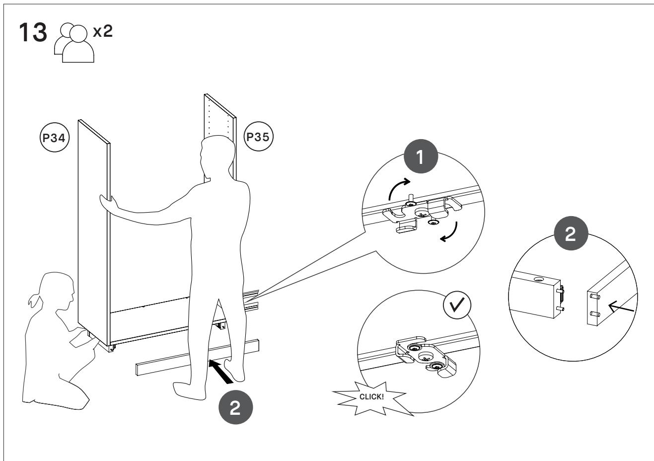
1. Setze das Scharnier unter den Unterboden, um die Schienen mit dem Boden zu verbinden. Du solltest es klicken hören, sobald das Scharnier eingerastet ist.
