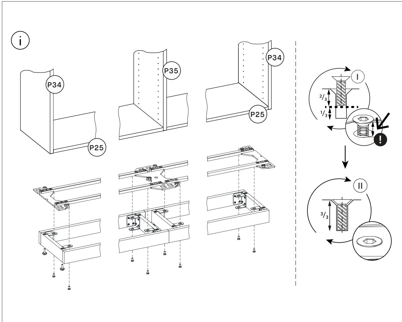
Général : les platines de fixation de pied se placent sous les panneaux extérieurs et les platines de fixation pied double se placent sous les panneaux intérieurs.
