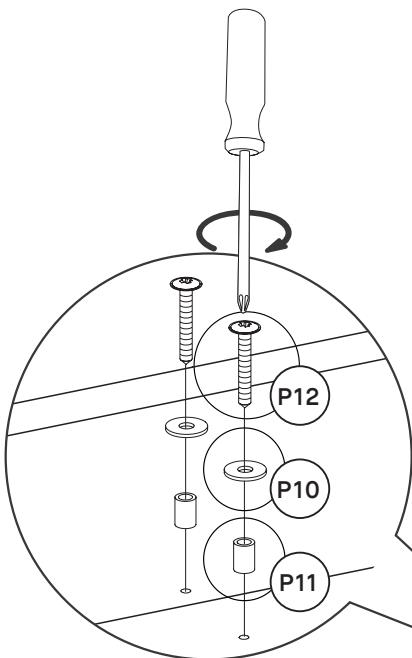
Vissez l'entretoise **P11** avec la rondelle **P10** aux tablettes rainurées **P25** en utilisant la vis **P12** (3,5x25mm).
