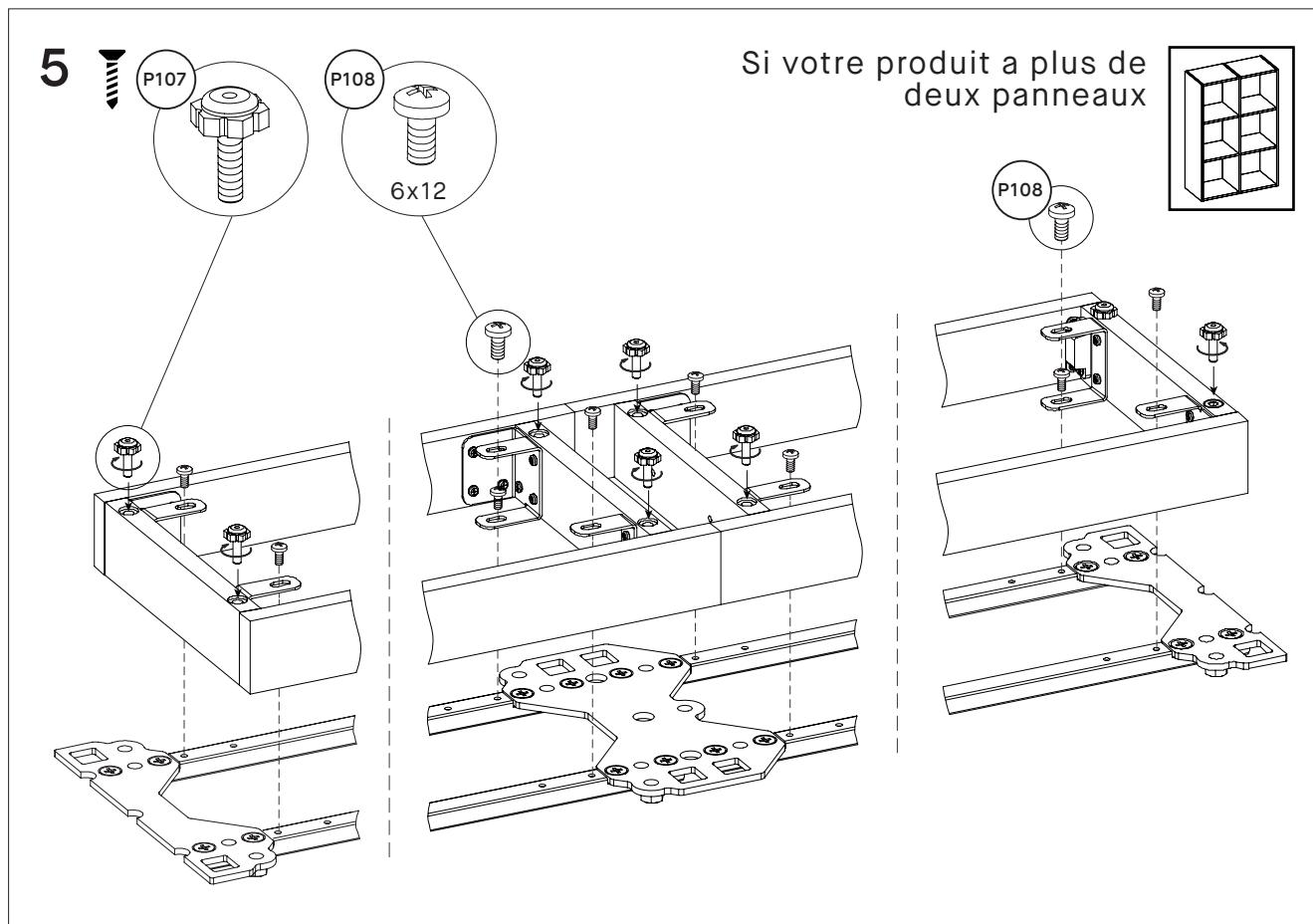
**Si votre meuble a plus de deux panneaux : connectez le socle avec les platines de fixation pied en utilisant la vis P108 comme vous le voyez ci-dessus.**
