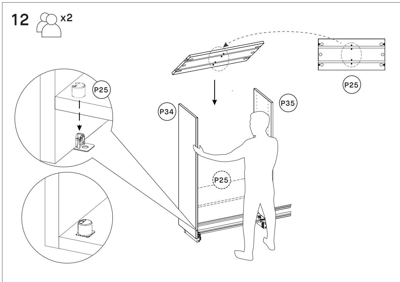
Posez la tablettes rainurées **P25** sur les ferrures d'assemblage pour la joindre aux panneaux verticaux **P34/P35** avec l'aide d'une tierce personne.
