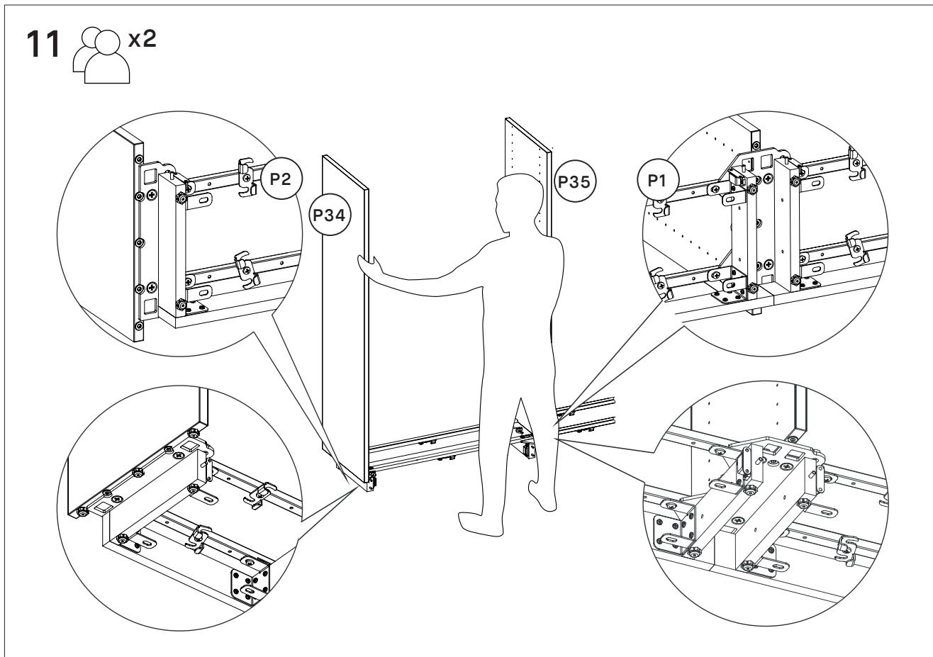
Maintenant, placez les deux premiers panneaux sur les platines de fixation : les panneaux extérieurs se fixent sur les platines de fixation pied simple P2, les panneaux intérieurs se fixent sur les platines de fixation pied double P1.
