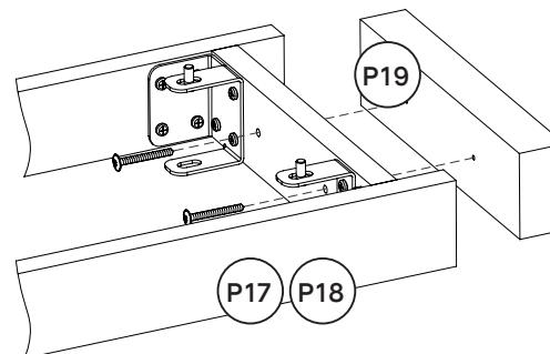
Si votre meuble n'a pas plus de deux panneaux : connectez le cache socle P19 avec les socles P17/ P18 (selon la configuration) en utilisant la vis P22.
