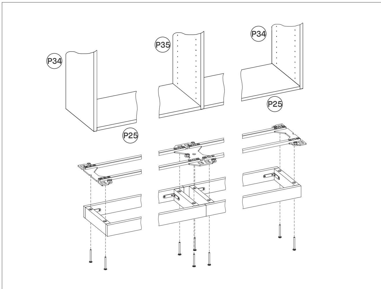
Général : les platines de fixation de pied se placent sous les panneaux extérieurs et les platines de fixation pied double se placent sous les panneaux intérieurs.
