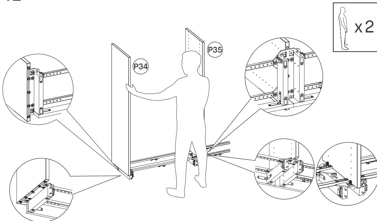
Maintenant, fixez les deux premiers panneaux sur les platines de fixation : les panneaux extérieurs se fixent sur les platines de fixation pied P2, les panneaux intérieurs se fixent sur les platines de fixation pied doubles P1.
