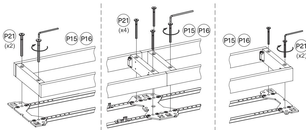
Si votre meuble a plus de deux panneaux : connectez le socle avec les platines de fixation pied en utilisant la vis P21 comme vous le voyez ci-dessus.
