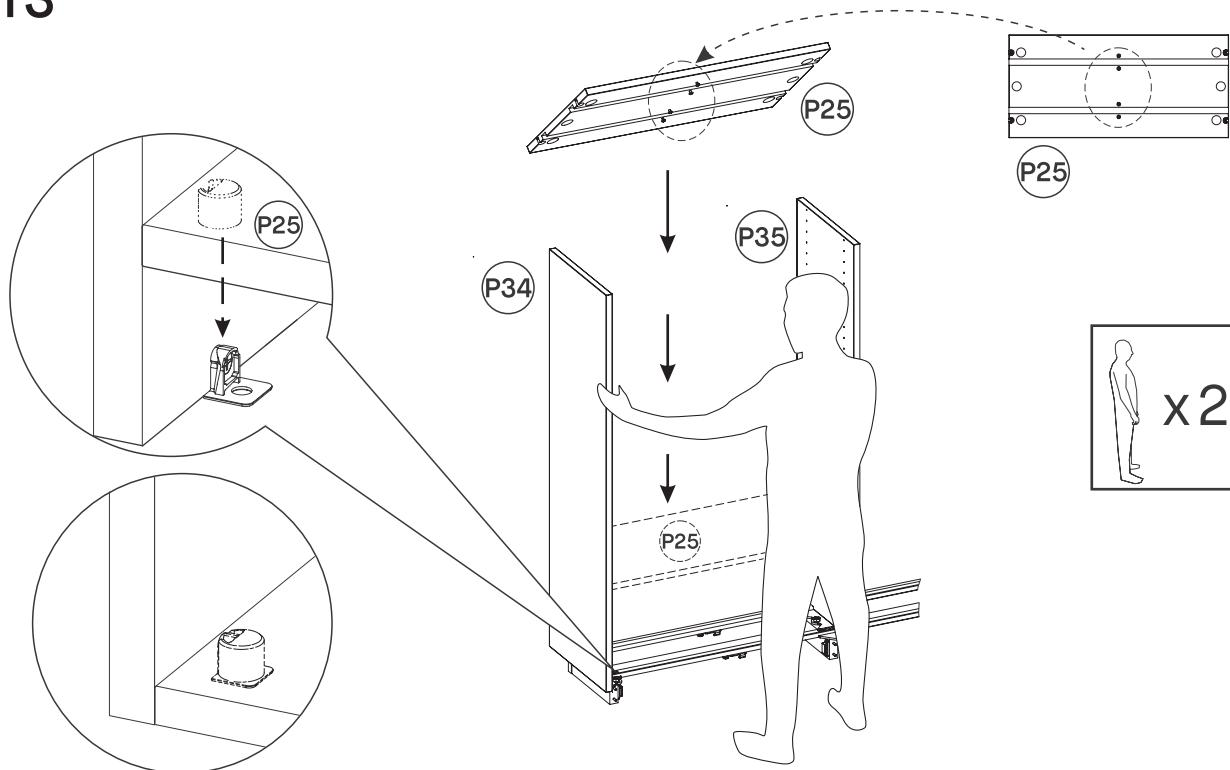
Posez les tablettes rainurées P25 sur les ferrures d'assemblage pour la joindre aux panneaux verticaux P26 avec l'aide d'une tierce personne.
