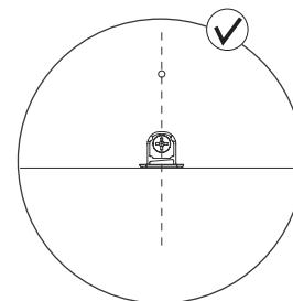
Les ferrures d'assemblage P13 sont là pour maintenir les tablettes rainurées. Vissez-les à tous les panneaux verticaux comme illustré ci-dessus (en utilisant la vis P14).
