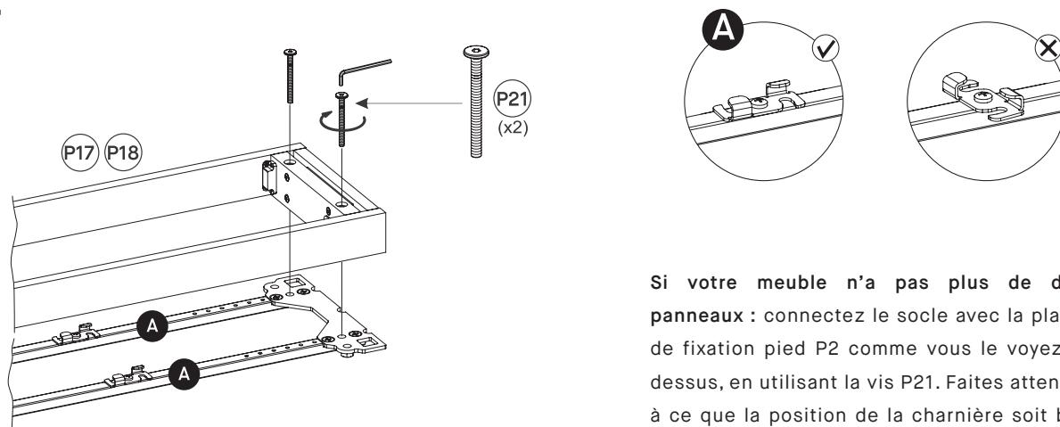
Si votre meuble n'a pas plus de deux panneaux : connectez le socle avec la platine de fixation pied P2 comme vous le voyez ci-dessus, en utilisant la vis P21. Faites attention à ce que la position de la charnière soit bien comme celle de l'image A (à droite).
