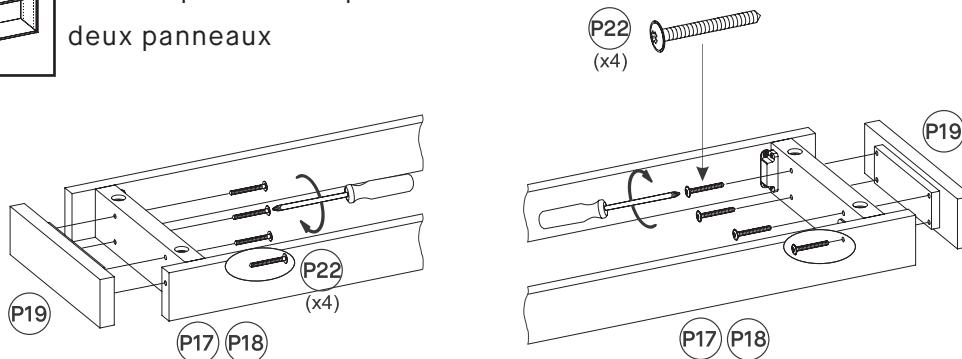
Si votre meuble n'a pas plus de deux panneaux : connectez le cache socle P19 avec les socles P17/ P18 (selon la configuration) en utilisant la vis P22.
