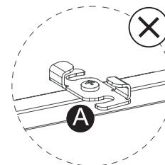
Si votre meuble n'a pas plus de deux panneaux : connectez le socle avec la platine de fixation pied P2 comme vous le voyez cidessus, en utilisant la vis P21. Faites attention à ce que la position de la charnière soit bien comme celle de l'image A (à droite).
