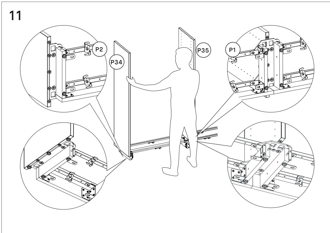
Maintenant, fixez les deux premiers panneaux sur les platines de fixation : les panneaux extérieurs se fixent sur les platines de fixation pied P2, les panneaux intérieurs se fixent sur les platines de fixation pied doubles P1.
