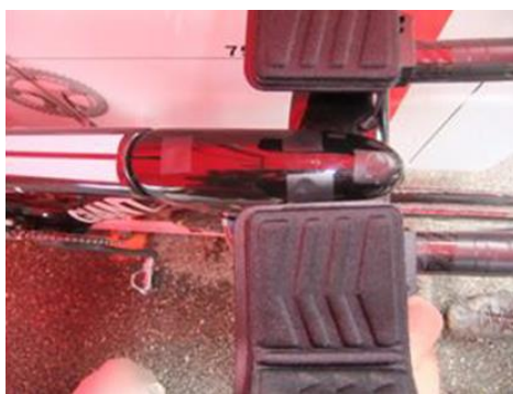
Figure 4 : Illustration de l'ajout de scotch pour couvrir l'accès aux vis
