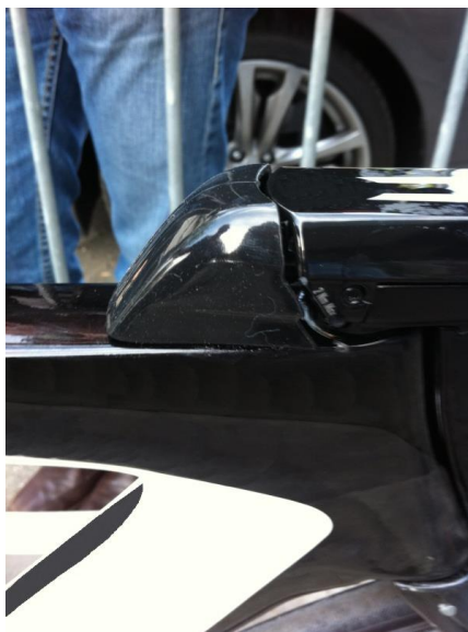
Figure 52 : Cache ajouté au cadre pour couvrir les câbles de frein
