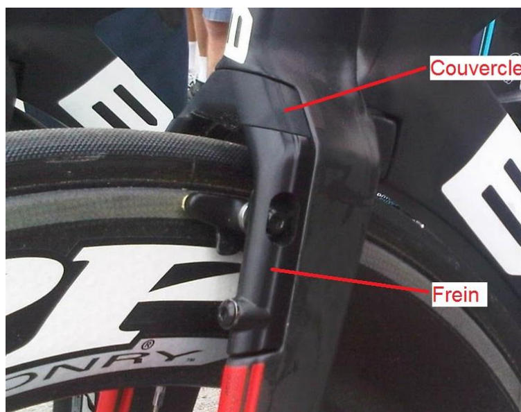
Figure 53 : Frein intégré à la fourche muni d'un couvercle
