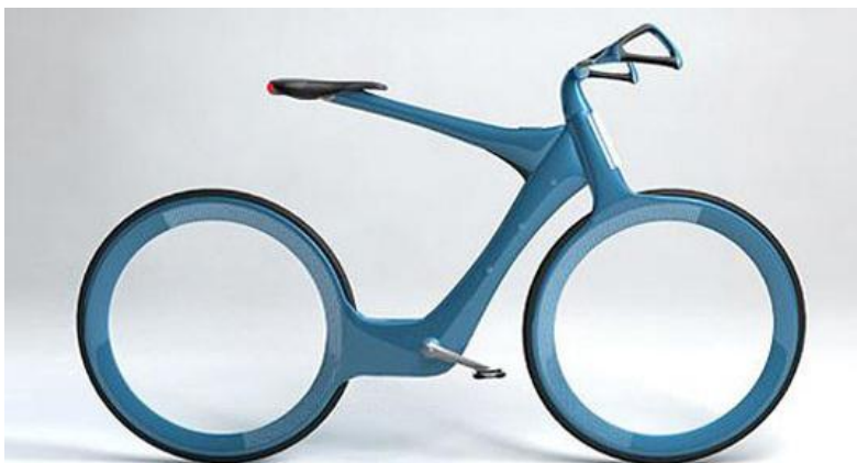
Figure 13 : Géométrie possible d'une bicyclette ne répondant pas aux règles de l'UCI
