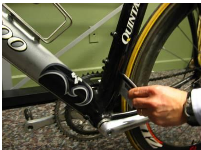
Figure 64 : Insertion d'une carte rigide entre la roue et le cadre afin de vérifier l'absence de carénage
