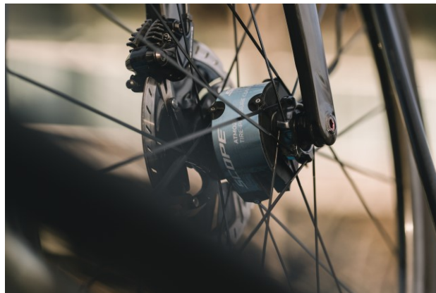
Le système Scope Cycling Atmoz installé sur le moyeu avant.
