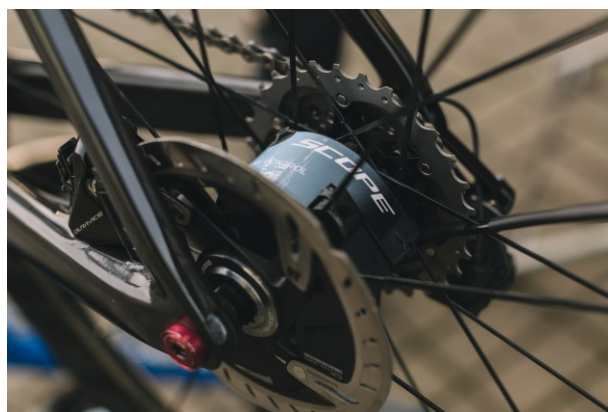
Le système Scope Cycling Atmoz installé sur le moyeu arrière.
