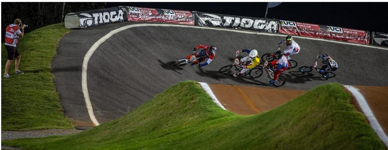
Les bords en pente douce recouverts d'herbe ralentissent l'érosion et réduisent les risques de blessure en cas de sortie de piste d'un coureur.
