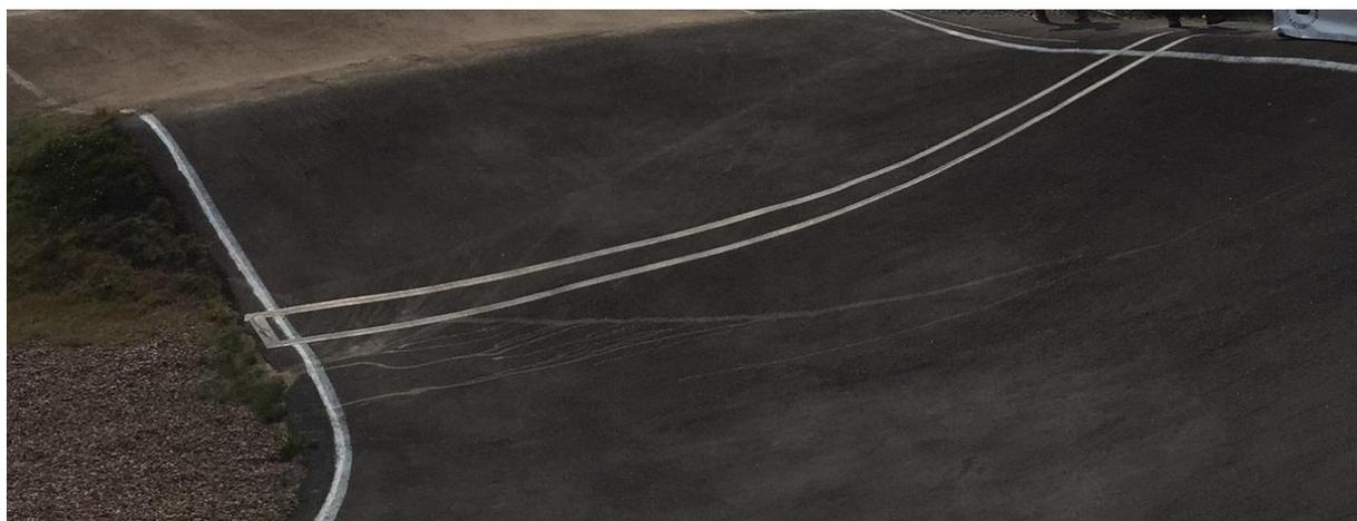
Une boucle de transpondeur installée à travers la piste à un point de chronométrage intermédiaire. Un ruban adhésif à forte adhérence a été utilisé pour attacher les fils électriques à la surface de la piste. Cela peut être une bonne solution, tant que le ruban adhésif offre une bonne adhérence et colle bien à la piste. La surface du ruban adhésif est similaire à celle du revêtement supérieur d'un skateboard.
