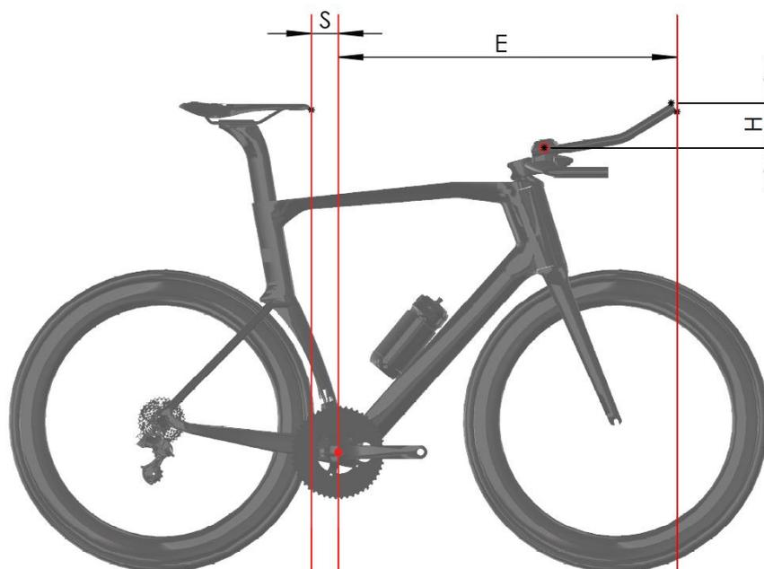
La mesure E correspond à la distance horizontale entre les plans verticaux passant par le centre de l'axe du pédalier et l'extrémité des extensions fixes du guidon de contre-la-montre, y compris les accessoires.
