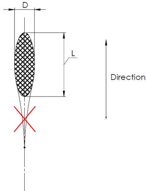
Le fuselage consiste à allonger ou effiler un profil. Le fuselage est toléré dans la mesure où le rapport de la longueur L au diamètre D ne dépasse pas les spécifications dimensionnelles établies telles que définies aux articles 1.3.020 (cadres), 1.3.022 et 1.3.023 (guidons, cintres de base et extension fixe du cintre de contre-la-montre).
