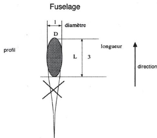
Figure 56 : Illustration de la règle 1:3 limitant le fuselage des éléments
