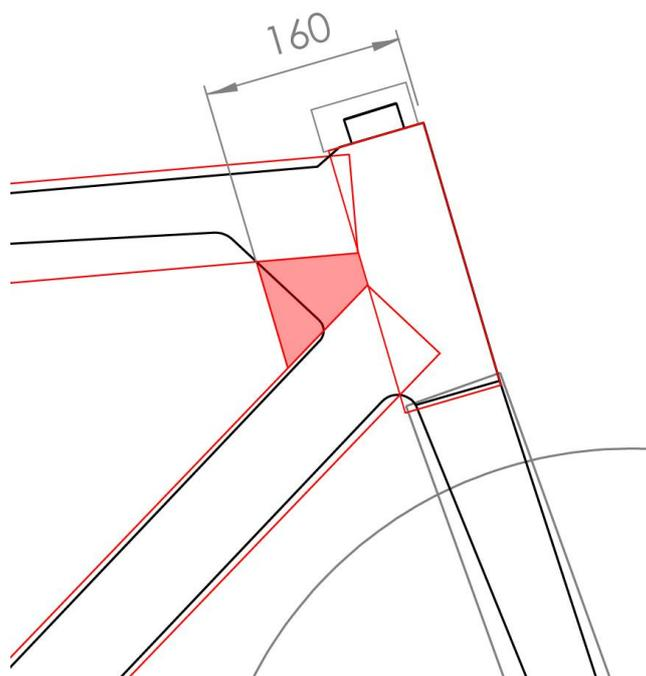
Figure 17: Illustration de la zone de compensation
