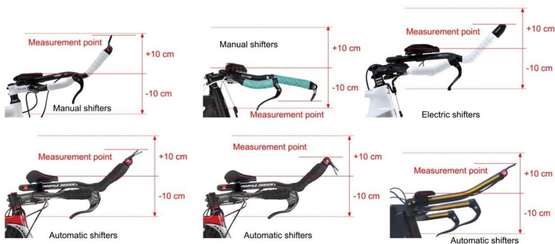
Figure 86 : Points de mesure pour les limites verticales de l'extension fixe additionnelle du guidon de contre-la-montre avec tous ses accessoires
