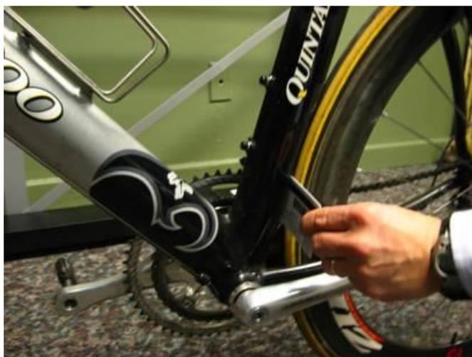
Figure 60 : Insertion d'une carte rigide entre la roue et le cadre afin de vérifier l'absence de carénage
