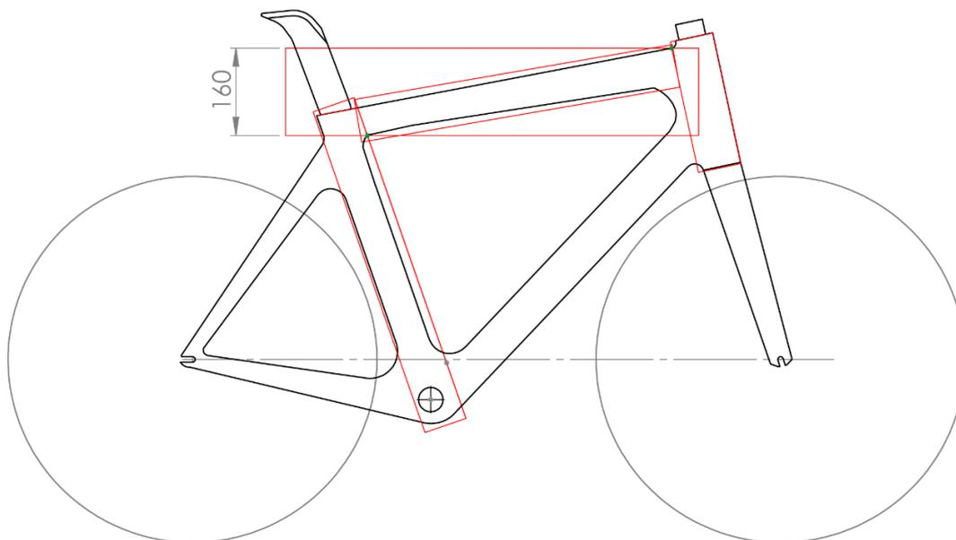
Figure 24 : Illustration d'un cas d'inclinaison maximale
