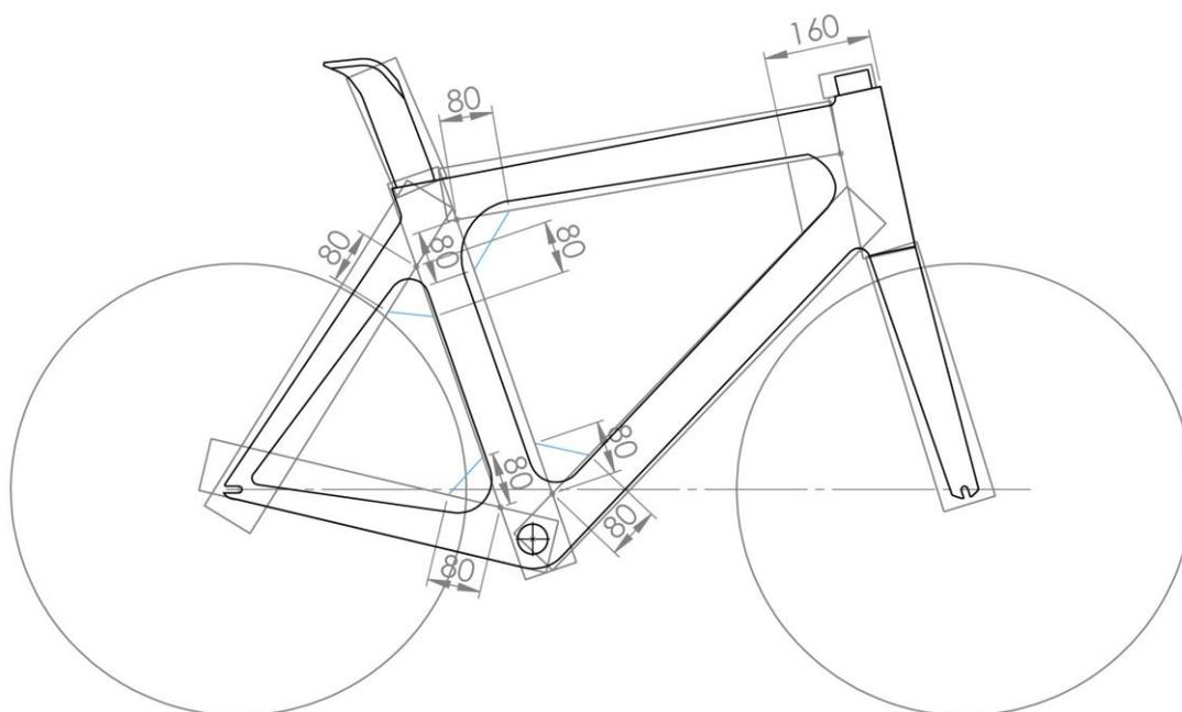
Figure 12 : Illustration des boîtes des triangles de compensation
