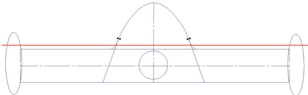
*Figure 58 : Exemple de la définition de la forme d'une potence quand la potence et le guidon sont monoblocs.*
