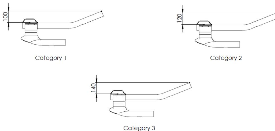
Figure 75 : Exemples des limites verticales par catégorie de taille (selon les dispositions de l'article 1.3.023)
