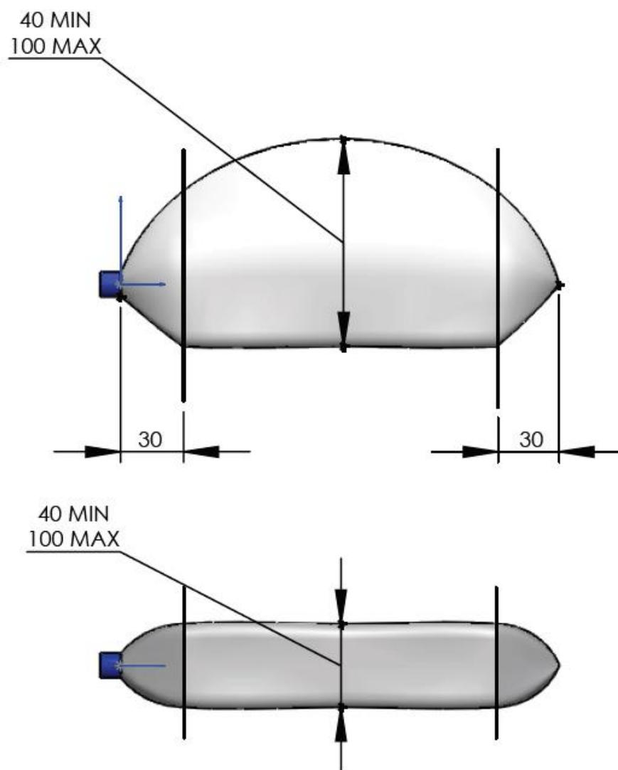
Figure 54 : Illustration des zones du bidon où les dimensions sont règlementées
