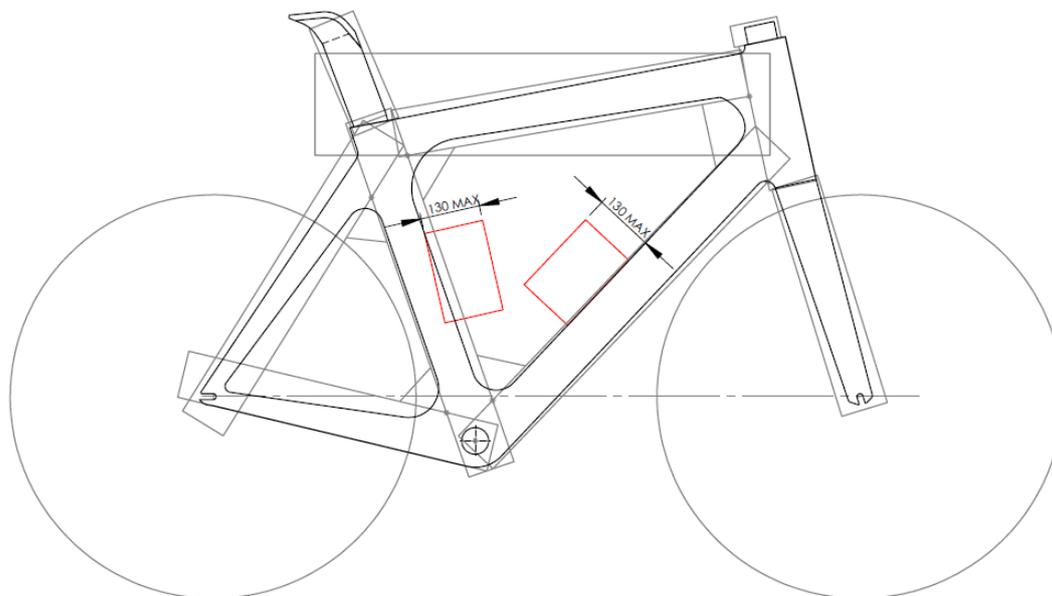
Figure 63 : Illustration du positionnement des boîtes de porte-bidon
