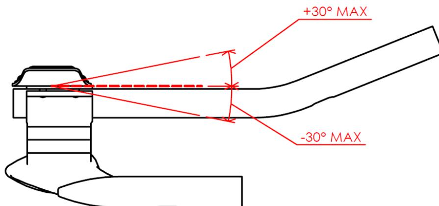
Figure 97 : Illustration de l'inclinaison maximale de chaque support d'avant-bras
