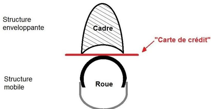
Figure 59 : Illustration du carénage des roues
