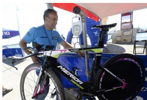
Figure 9: Mesure du poids d'une bicyclette
