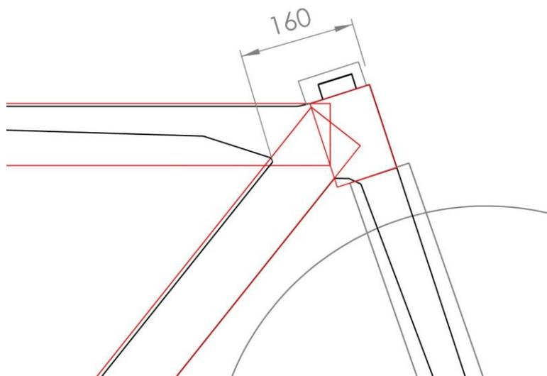
Figure 13: Illustration de la règle des 160 mm
