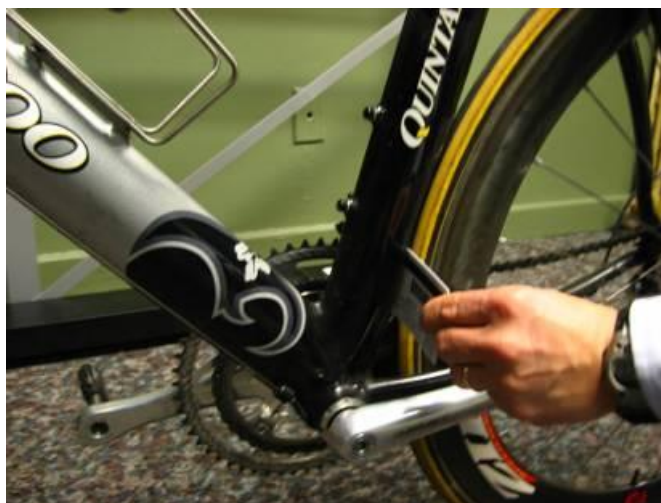
Figure 57 : Insertion d'une carte rigide entre la roue et le cadre afin de vérifier l'absence de carénage
