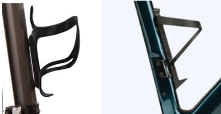
Figure 58 : Illustration d'un espace physique (à gauche) et visuel (à droite) entre le bidon et le tube auquel il est fixé.
