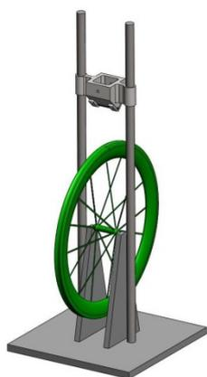
Image 1 : Dispositif de test de chute verticale
