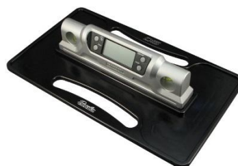
Figure 7 : Appareil de mesure officiel pour contrôler l'inclinaison des selles
