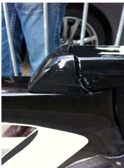
Figure 59 : Cache ajouté au cadre pour couvrir les câbles de frein
