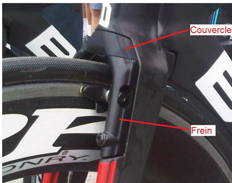
Figure 60 : Frein intégré à la fourche muni d'un couvercle
