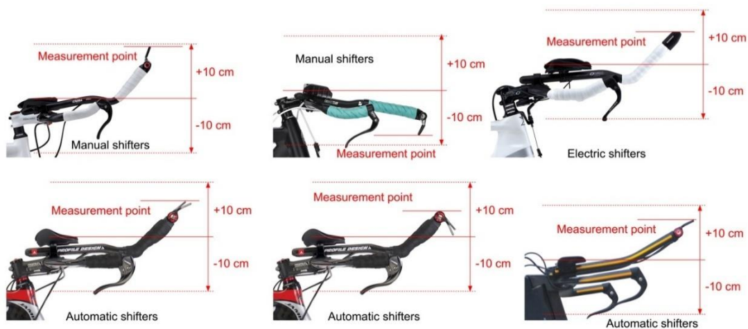
Figure 53 : Points de mesure pour les limites verticales de l'extension fixe additionnelle du guidon de contre-la-montre avec tous ses accessoires
