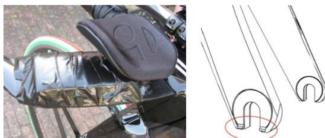
Figure 1 : Quelques exemples de modification de l'équipement interdit (ajout de tape, l'image des ergots de fourche)
