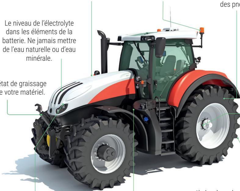
L'état de serrage des écrous des roues.
