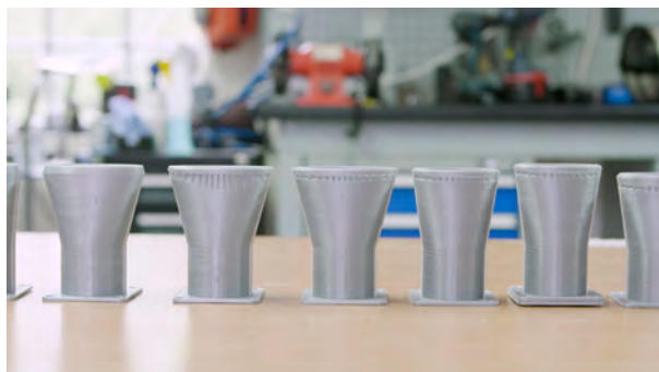
Iterationen des komplexen Düsendesigns (L) und des endgültigen 3D-Druckteils in Aktion (R)
