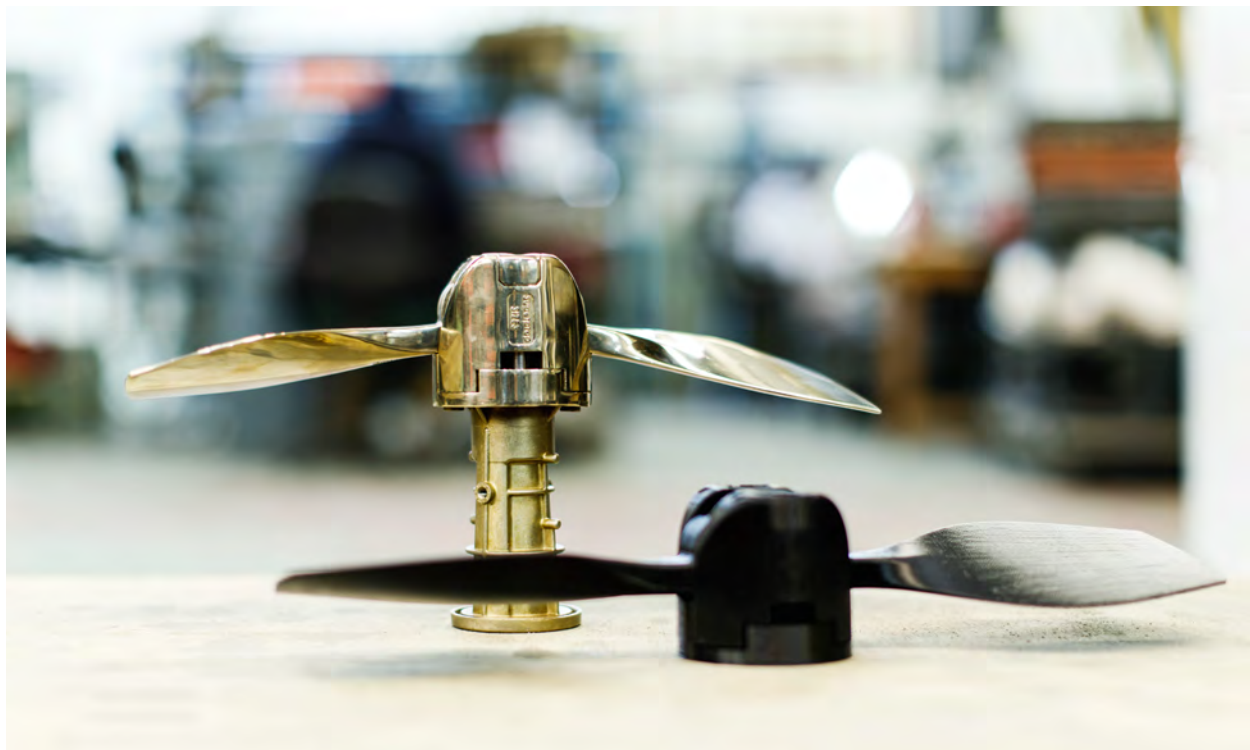
Ein auf einem Ultimaker-Drucker in 3D gedruckter Propeller-Prototyp neben der endgültigen Produktionsversion
