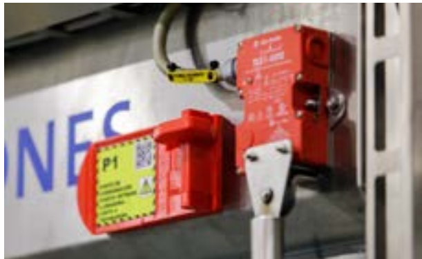
メンテナンス中にマシンの起動を防止する3Dプリンティングされた安全ロック
