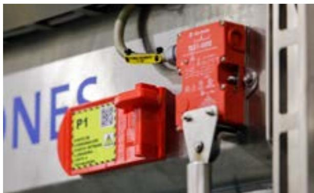
*Pestillo de seguridad impreso en 3D para evitar que las máquinas se pongan en marcha durante el mantenimiento*
