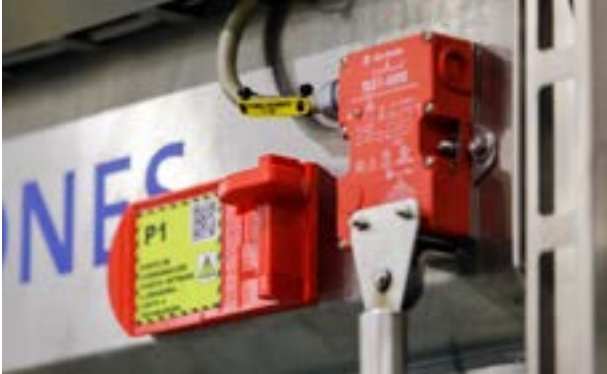
정비 중에 기기 가동을 방지하는 3D 프린팅 안전 잠금장치
