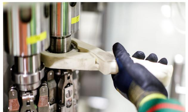
*3D gedruckte Werkzeuge erleichtern die Wartung und sind weniger Zeitintensiv*
