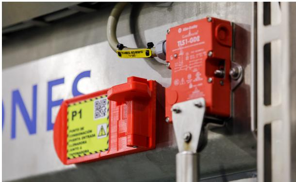
*Das 3D - gedruckte Sicherheitsschloss verhindert das Anlaufen von Maschinen während der Wartung*
