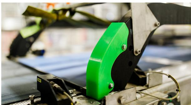
*3D-gedruckte funktionsfähige Ersatzteile können ohne Bestand erstellt werden*
