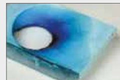
Ekstruderet polystyren (XPS), brandhæmmende, efter 1 min.
