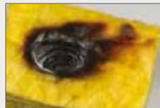
Mineraluld på glasbasis efter 7 minutter.
