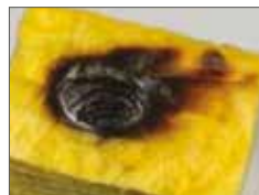
Figur 66: Mineraluld på glasbasis efter 7 minutter.
