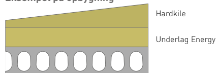
Figur 25: HARDKILE Eksempel på opbygning
