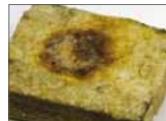
Figur 67: ROCKWOOL stenuld efter 30 minutter.
