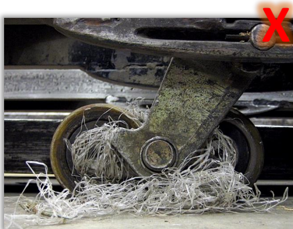
Nylonverkko kiertyneenä trukin pyörien ympärille.
