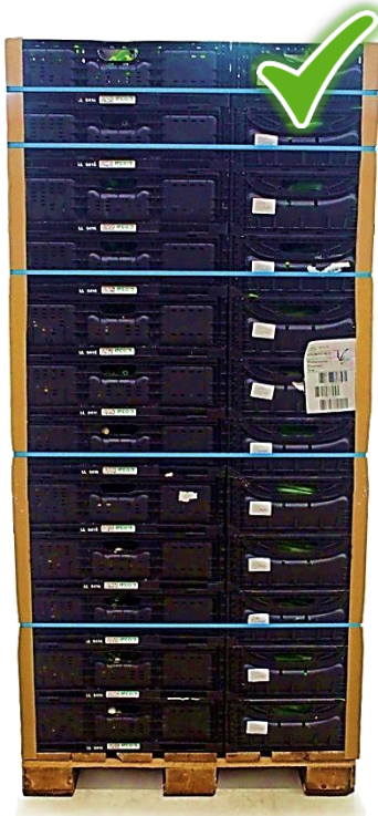
Esimerkki hedelmä- / vihanneslavakuorman sidonnasta
