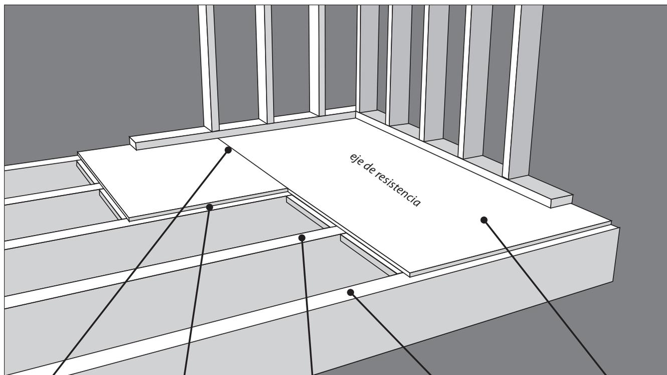
Se recomienda una separación de 1/8" en todas las viguetas de bordes y extremos eje de resistencia
