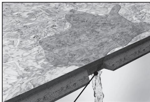
*Las muescas verticales en el perfil de la lengüeta permiten que el agua drene rápidamente del contrapiso durante la construcción*
