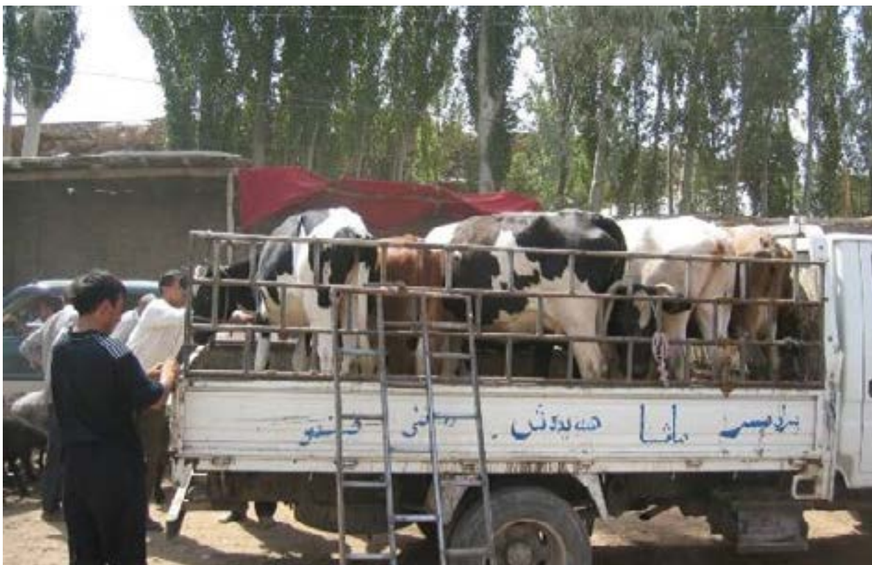
图4.13. 这辆卡车的侧栏太矮，没有足够的视觉屏障，无法防止牲畜试图逃跑。来源：Anon。
