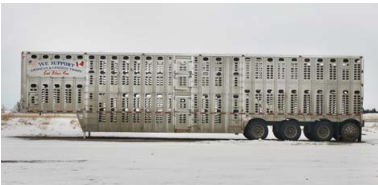
图4.14. 特制的活牛运输拖车提供了可对抗极端温度的通风（安装了侧板，冬季时可封住外部通风孔）和保护。来源：国际农业发展基金会。
