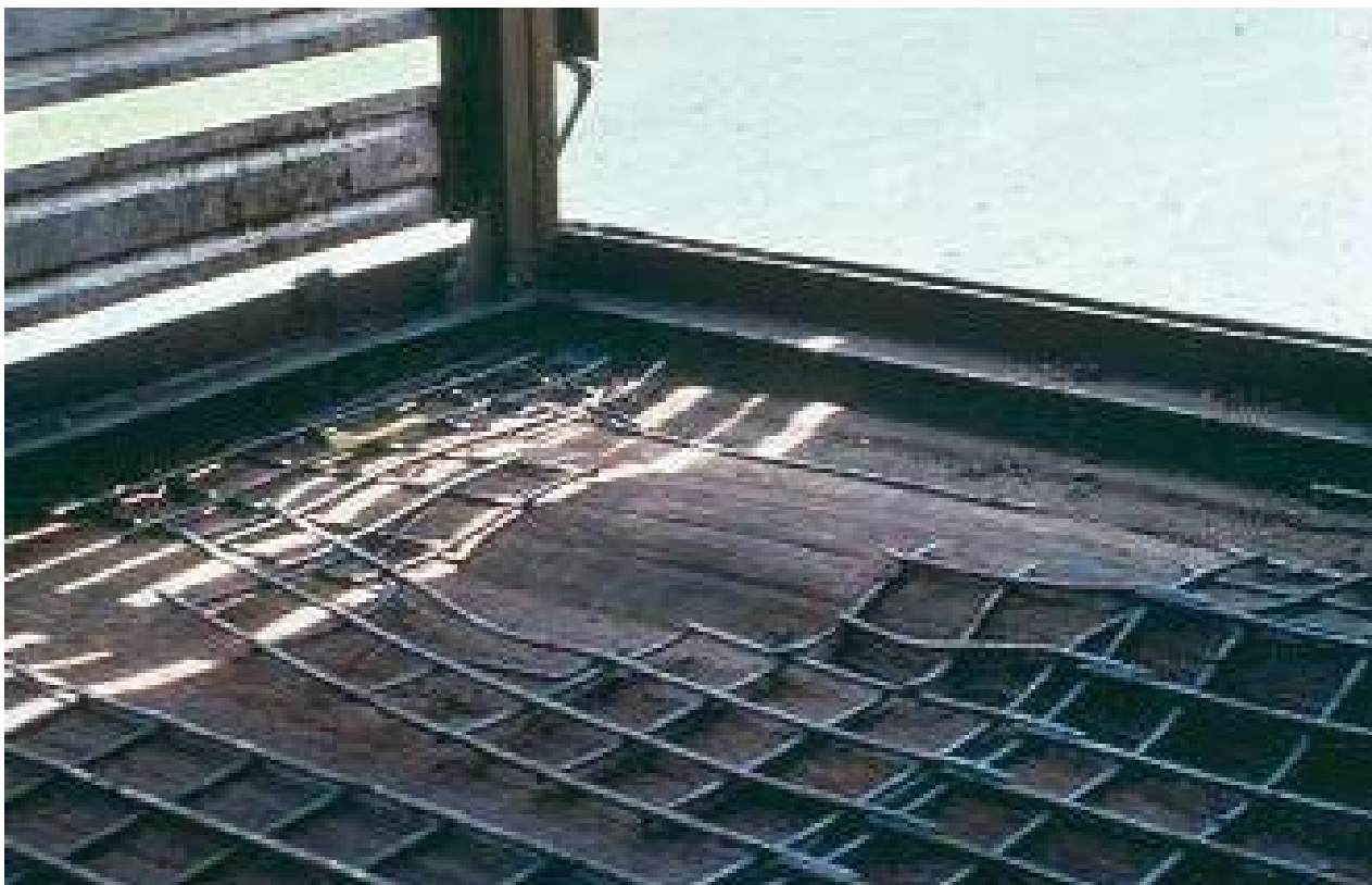
图4.12. 钢筋网太细，不能用作卡车地板，会断裂并造成牛只受伤。来源：澳大利亚牲畜出口公司与澳大利亚肉类及畜牧业公司。
