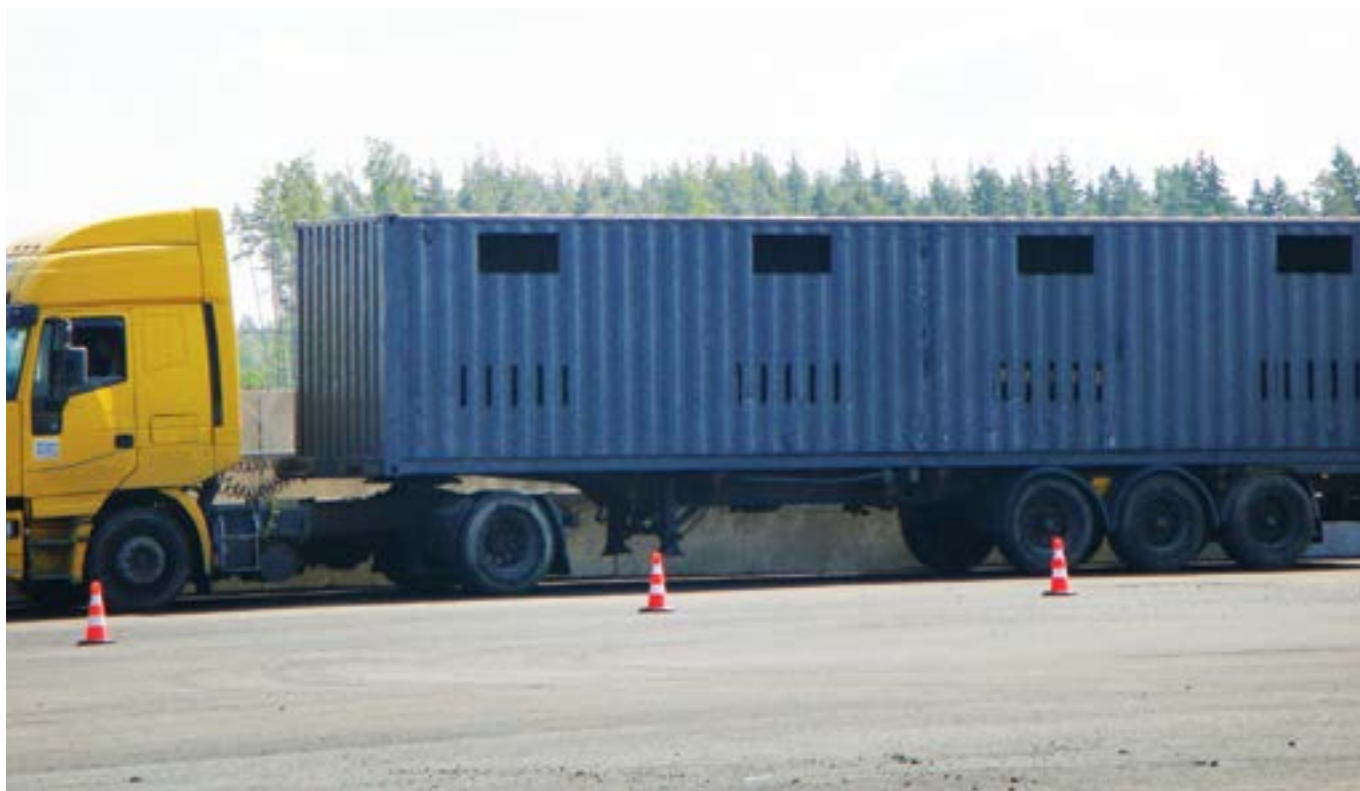
图4.15. 用船运集装箱改造的活牛运输拖车。来源：ExpoTrade。
