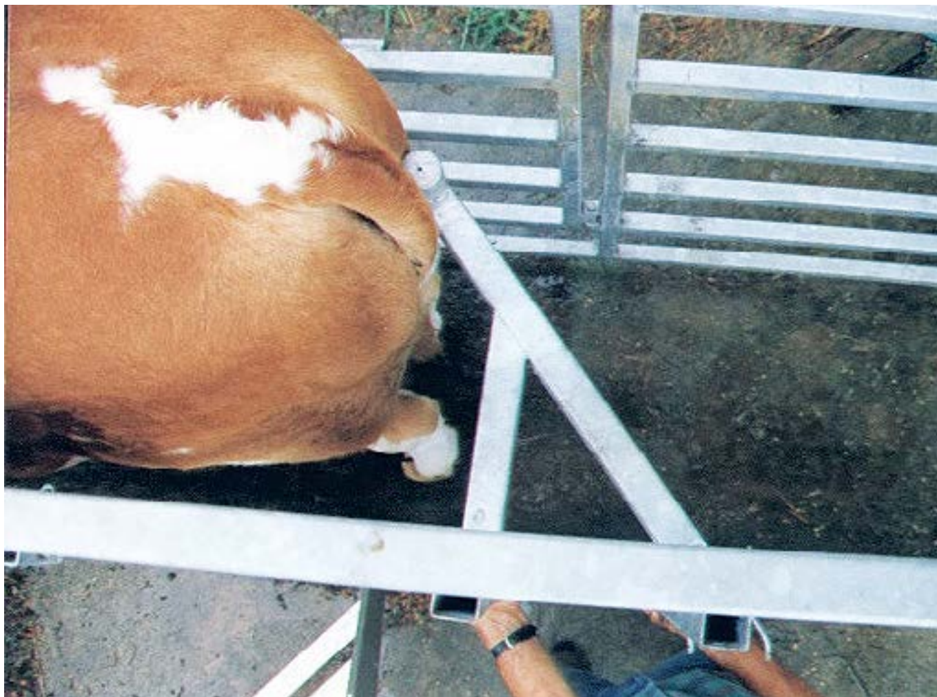
图2.13. 通道内的防后退装置。牛只可轻松地推开通道中的防后退装置向前走穿过通道，而借助小弹簧的压力，该装置在牲畜走过后“弹回”原位并阻止牲畜后退。来源：Holdem牛只处理设备。
