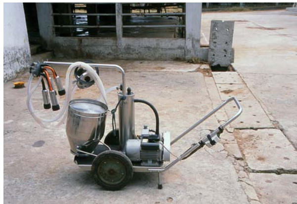
Elektrik motorlu bağımsız sağım makinesi, mikroplu bir ineğin sütünün toplu süt depolamaya girmemesi için kullanılır.
