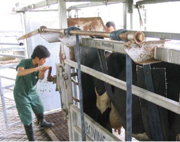
Karın bantlı ayak dengeleme makinesi ineği destekler ve aşırı büyümüş ayağı daha kolay dengelemek için ayağı vinçle kaldırır.
