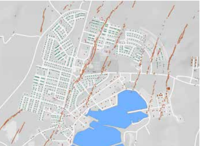
Mynd 2 Sýnilegar sprungur á yfirborði í Grindavík. Grænir punktar sýna íbúðarhúsnæði og rauðir sýna atvinnhúsnæði.
