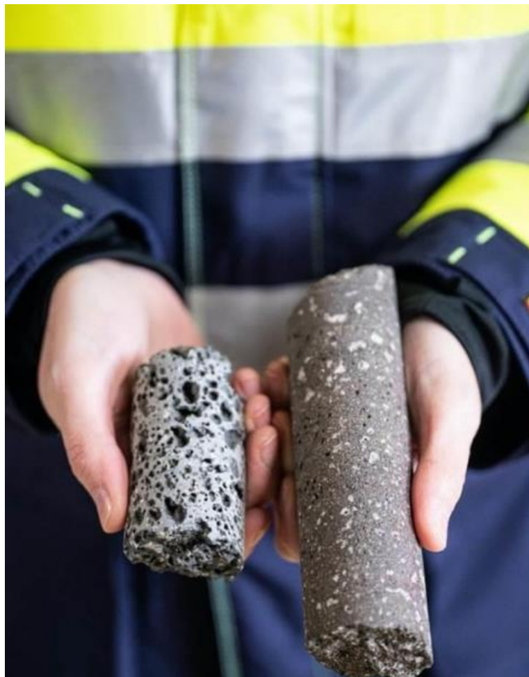
Mynd 4.3 Dæmi um basaltberg þar sem engar útfellingar steinda hafa átt sér stað (vinstra megin) og basaltberg þar sem steindir á borð við kalsít (kalsíumkarbónat) hafa fallið út í sprungum og holrýmum líkt og gerist við niðurdælingu \text{CO}_2 með Carbfix aðferðinni. Mynd: Carbfix.
