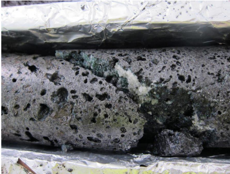
Mynd 4.2 Steinrunnið \text{CO}_2 , í formi karbónatsteinda (hvítar útfellingar) í basaltkjarna frá um 500 m dýpi á tilraunasvæði Carbfix í Þrengslum). Mynd: Carbfix.
